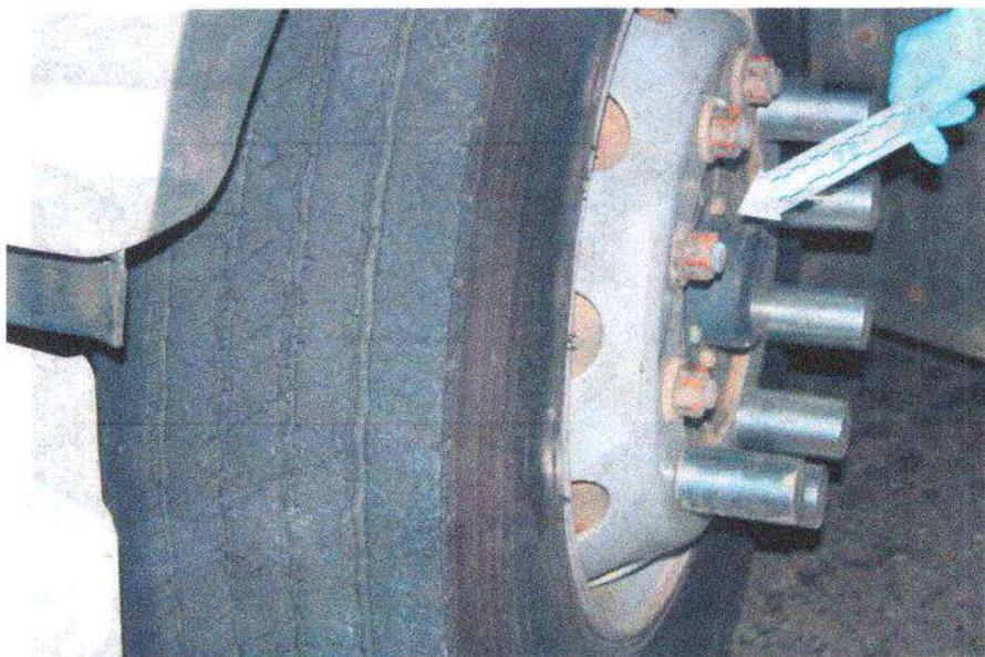
**IMAGEN 31 PLANO MEDIO:** EN ESTA IMAGEN SE PUEDE APRECIAR **ELEMENTO MATERIAL PROBATORIO NUMERO 8 EL CUAL CORRESPONDE A PARTES FALTANTES DE ACCESORIOS (TAPA TUERCA), DE LA LLANTA DEL VERTICE ANTERIOR DEL COSTADO IZQUIERDO DEL RODANTE.**
