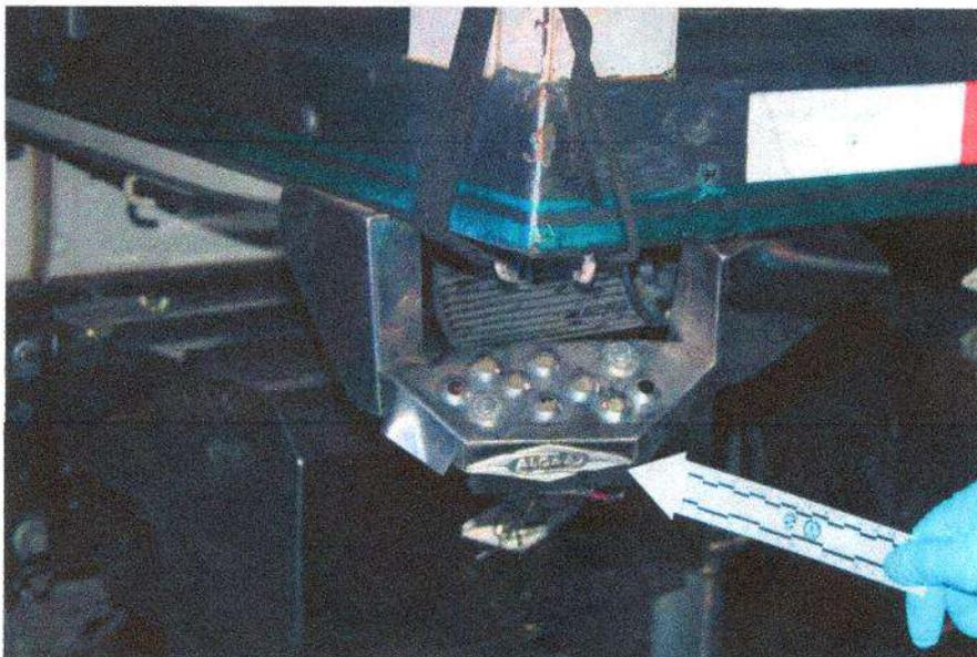
**IMAGEN 33 PLANO MEDIO:** EN ESTA IMAGEN SE PUEDE APRECIAR ELEMENTO MATERIAL PROBATORIO NUMERO 8 EL CUAL CORRESPONDE AL POSA PIE METÁLICO DEL VÉRTICE ANTERIOR DEL COSTADO IZQUIERDO DE LA CARROCERÍA (ESTACAS) DEL CUAL SE LOGRA APRECIAR ABOLLADURA SOBRE EL MISMO.
