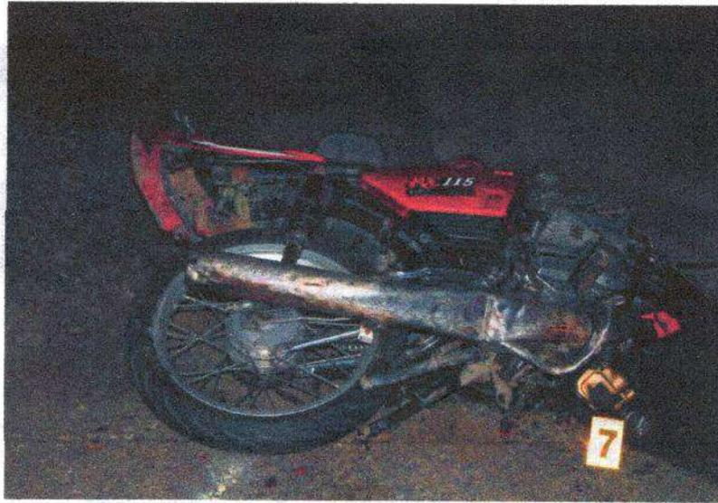
**IMAGEN 20 PLANO MEDIO:** EN ESTA IMAGEN SE PUEDE APRECIAR ELEMENTO MATERIAL PROBATORIO NÚMERO 7 DE LAS CARACTERÍSTICAS ANTES MENCIONADAS DE IGUAL FORMA SE LOGRA APRECIAR LA PARTE INFERIOR DEL RODANTE Y LOS DAÑOS SUFRIDOS POR EL RODANTE A RAZÓN DEL ACCIDENTE DE TRANSITO.
