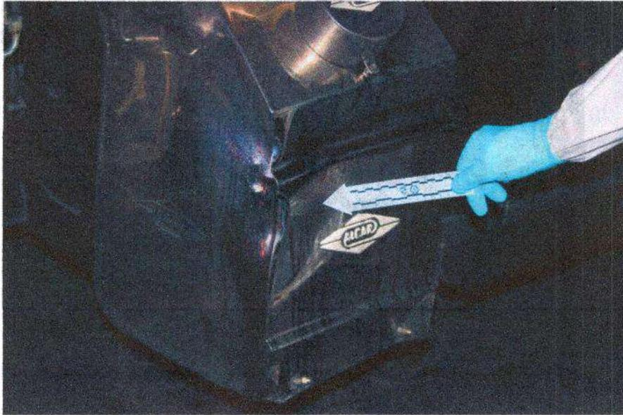
**IMAGEN 34 PLANO MEDIO:** EN ESTA IMAGEN SE PUEDE APRECIAR ELEMENTO MATERIAL PROBATORIO NUMERO 8 EL CUAL CORRESPONDE A UNA ABOLLADURA SOBRE ACCESORIO DEL RODANTE UBICADO SOBRE EL COSTADO IZQUIERDO EN LA PARTE INFERIOR COMO SE LOGRA APRECIAR EN LA IMAGEN.
