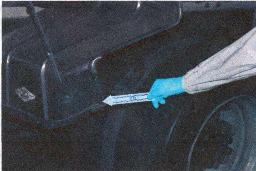
**IMAGEN 36 PLANO MEDIO:** EN ESTA IMAGEN SE PUEDE APRECIAR ELEMENTO MATERIAL PROBATORIO NUMERO 8 EL CUAL CORRESPONDE A UNA **ABOLLADURA SOBRE EL GUARDA BARROS UBICADO EN EL COSTADO IZQUIERDO INFERIOR DEL RODANTE EN EL TERCIO MEDIO** COMO SE LOGRA APRECIAR EN LA IMAGEN.
