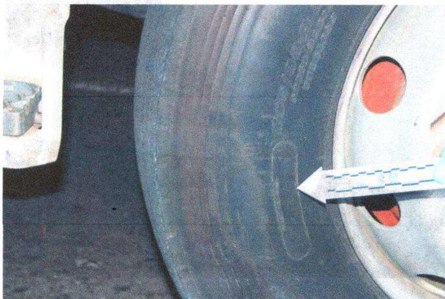
**IMAGEN 32 PLANO MEDIO:** EN ESTA IMAGEN SE PUEDE APRECIAR ELEMENTO MATERIAL PROBATORIO NUMERO 8 EL CUAL CORRESPONDE A UNA ZONA DE LIMPIEZA SOBRE LA CARA EXTERNA DE LA LLANTA DEL VÉRTICE ANTERIOR DEL COSTADO IZQUIERDO DEL RODANTE.
