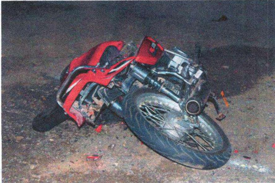
**IMAGEN 18 PLANO MEDIO: EN ESTA IMAGEN SE PUEDE APRECIAR ELEMENTO MATERIAL PROBATORIO NÚMERO 7 DE LAS CARACTERÍSTICAS ANTES MENCIONADAS DE IGUAL FORMA SE LOGRA APRECIAR EL TERCIO POSTERIOR DEL RODANTE Y LOS DAÑOS SUFRIDOS COMO LO SON DESPRENDIMIENTOS, PARTES FALTANTES, ROTURAS Y DEMÁS COMO SE LOGRA APRECIAR EN LA IMAGEN.**
