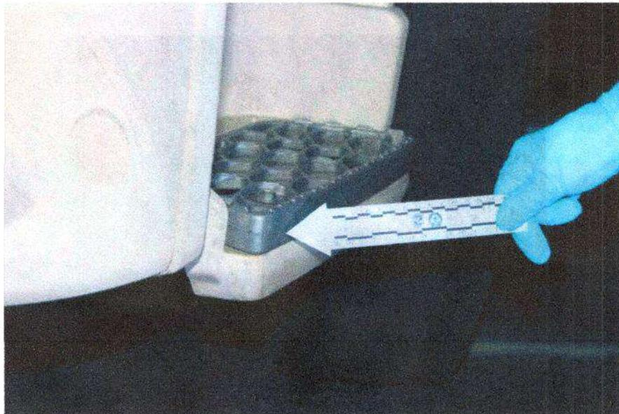
**IMAGEN 30 PLANO MEDIO:** EN ESTA IMAGEN SE PUEDE APRECIAR **ELEMENTO MATERIAL PROBATORIO NUMERO 8 EL CUAL CORRESPONDE A UNA ABOLLADURA SOBRE EL POSA PIE DEL COSTADO IZQUIERDO EL CUAL SE ENCUENTRA UBICADO DEBAJO DE LA PUERTA QUE DA INGRESO AL HABITÁCULO DEL CONDUCTOR DEL RODANTE.**
