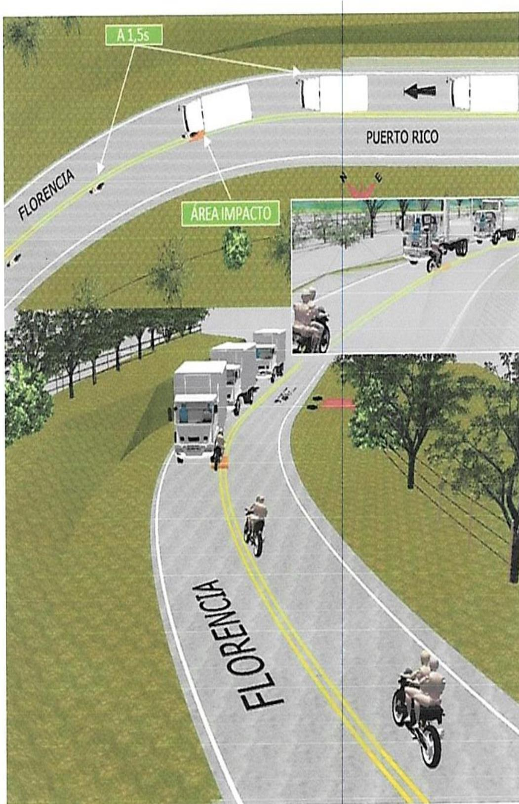
**IMAGEN No.20:** imagen compuesta de vista en planta y en 3D de la secuencia de desplazamiento de los vehículos pre impacto y el momento del impacto sobre la vía. se toma como referencia una ubicación probable a 1,5s utilizando las velocidades calculadas y un movimiento sin aceleraciones en ese lapso.
