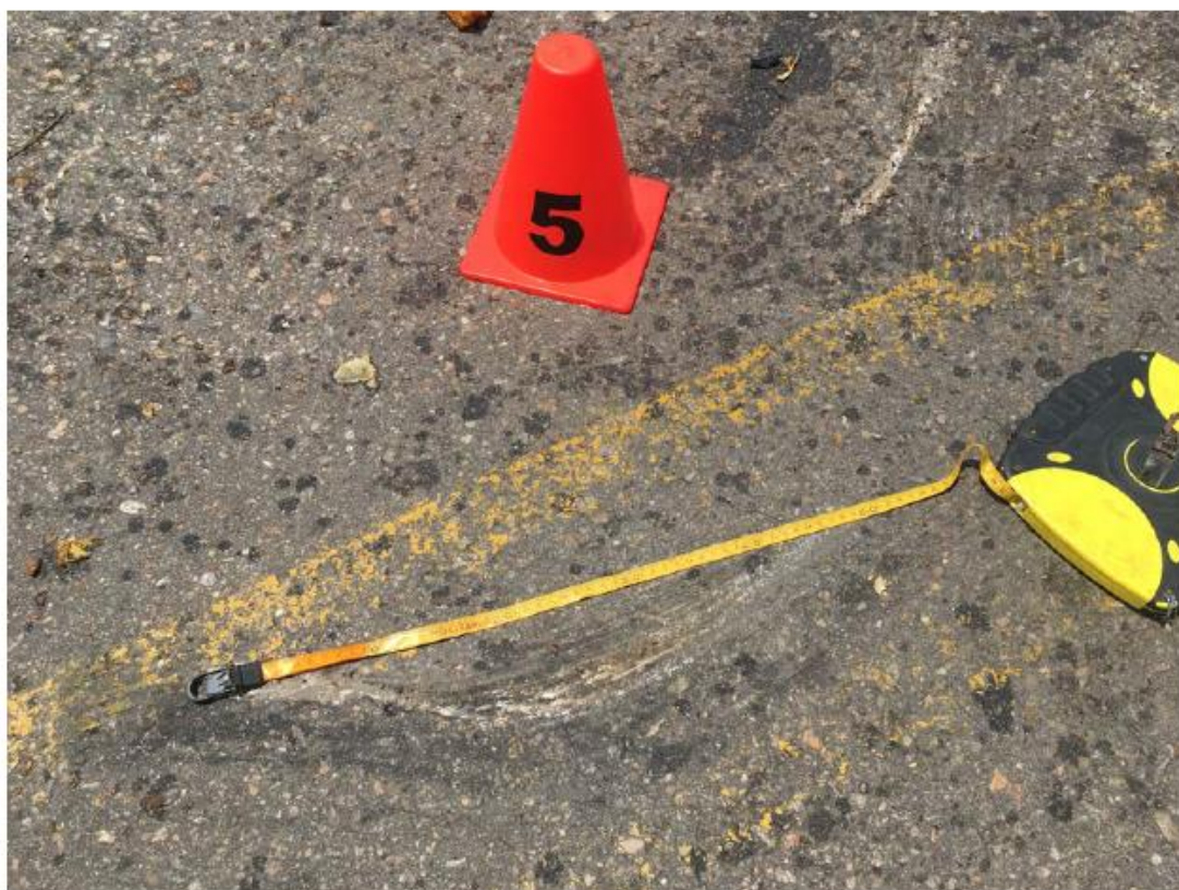
Figura 27. IMG_4816 registrada por la policía judicial. EMP-5: Huellas de arrastre de llanta y metálico. Con la cinta métrica se señala la huella de arrastre de llanta y metálica conformada con líneas curvas delgadas y paralelas entre sí. En la parte superior se observa una huella de arrastre de llanta con varias líneas rectas paralelas entre sí, con mayor grosor a la anterior, y una huella de arrastre metálico generando hendidura en el asfalto.
