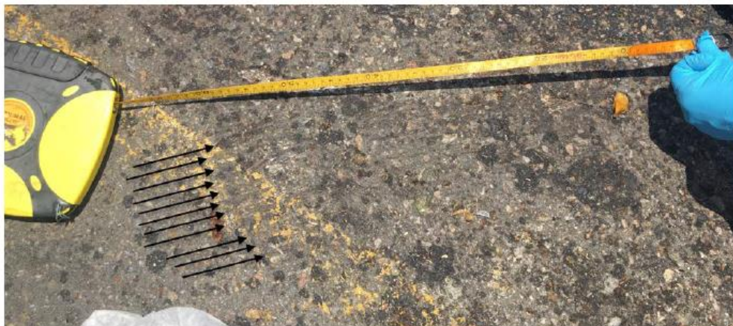
Figura 29. Se extrae parte de la figura anterior, para ilustrar con las flechas de color negro, las líneas paralelas de configuración la huella de arrastre de llanta marcada por el neumático trasero de la motocicleta.
