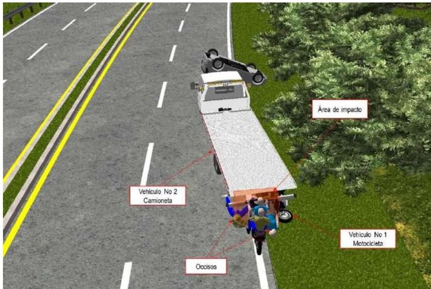
**Imagen No. 23:** En esta imagen en 3D, se observa la secuencia del accidente, nótese el sentido de desplazamiento de los vehículos, el área de impacto de color naranja. Elaborada en el software Trimble Forensic Reveal.
