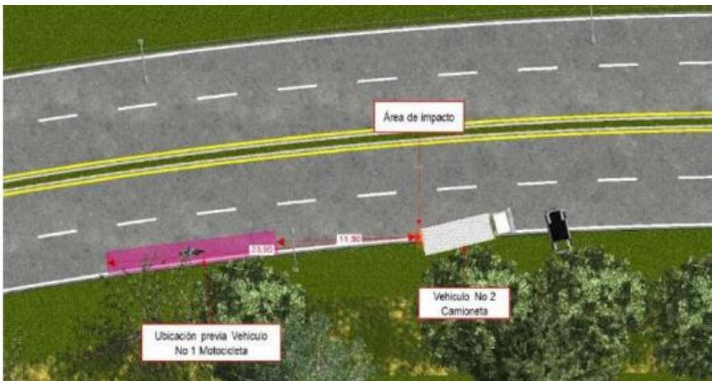
Imagen No.24: En esta imagen, se observa el área de ubicación relativa entre los vehículos involucrados 1,5s y 2,0s antes del área de impacto. Elaborada en el software Trimble Forensic Reveal
