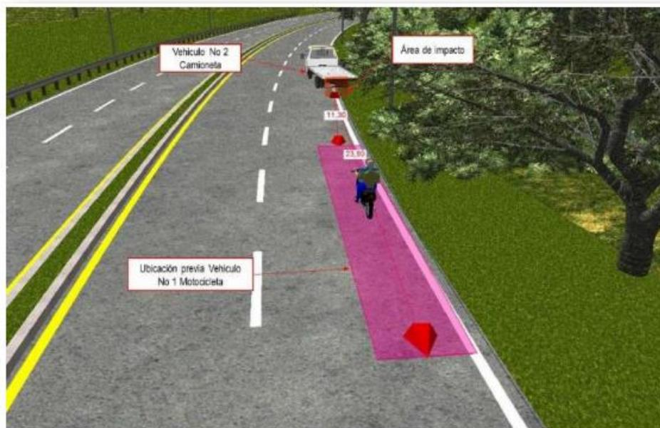
*Imagen No.26: En esta imagen, se observa el área de ubicación relativa entre los vehículos involucrados 1,5s y 2,0s antes del área de impacto. Elaborada en el software Trimble Forensic Reveal.*
