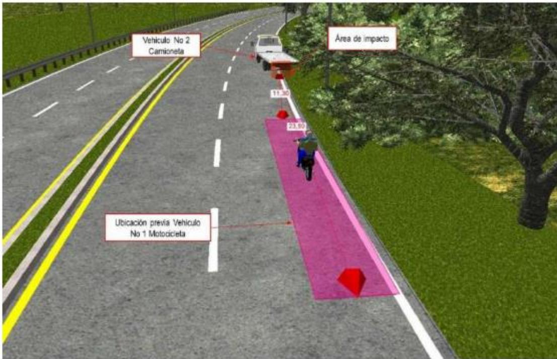
Imagen No.25: En esta imagen, se observa el área de ubicación relativa entre los vehículos involucrados 1,5s y 2,0s antes del área de impacto. Elaborada en el software Trimble Forensic Reveal.
