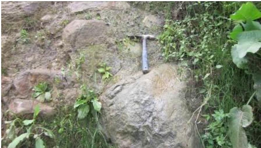
Figura 77. También se tienen bloques frescos de andesitas de hasta 1 metro de diámetro en la base del talud.
