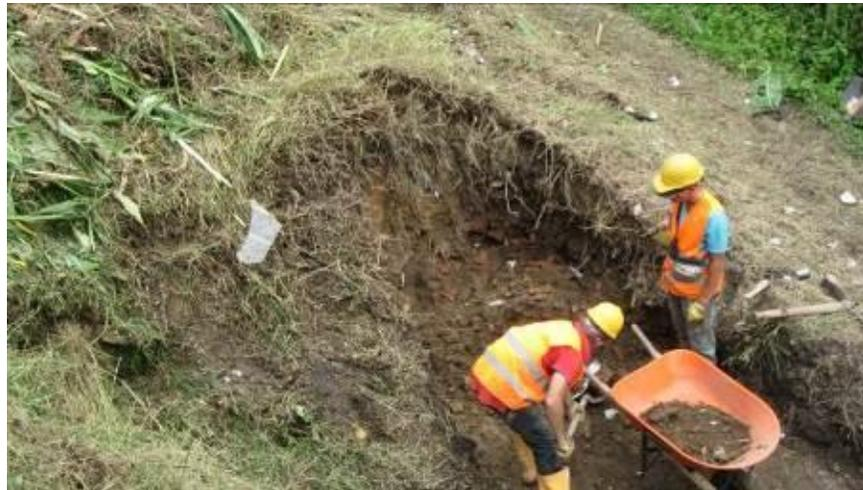
Figura 143. En la base de la ladera se tienen depósitos antròpicos.
