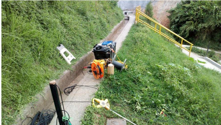
Figura 197. **Equipo adquisición de datos sísmicos LRS 9.**
