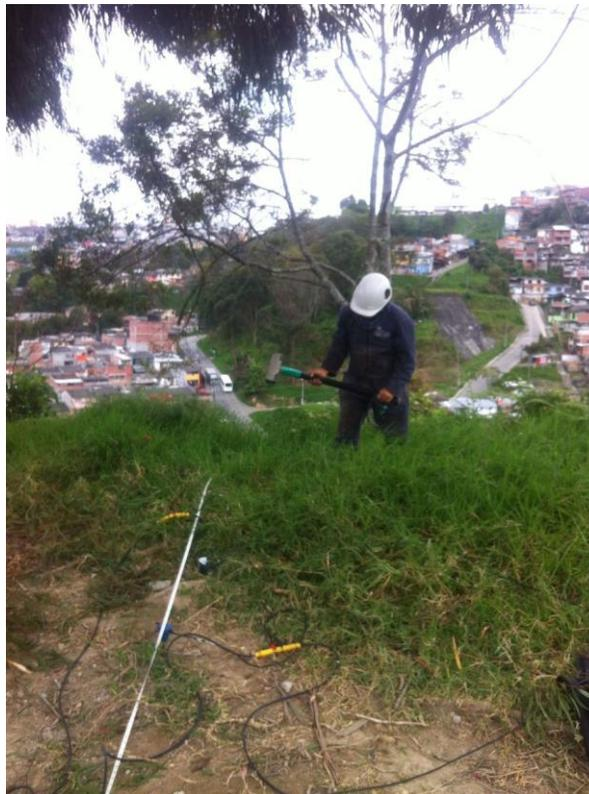
Figura 200. **Ensayo de refracción sísmica LRS 4**
