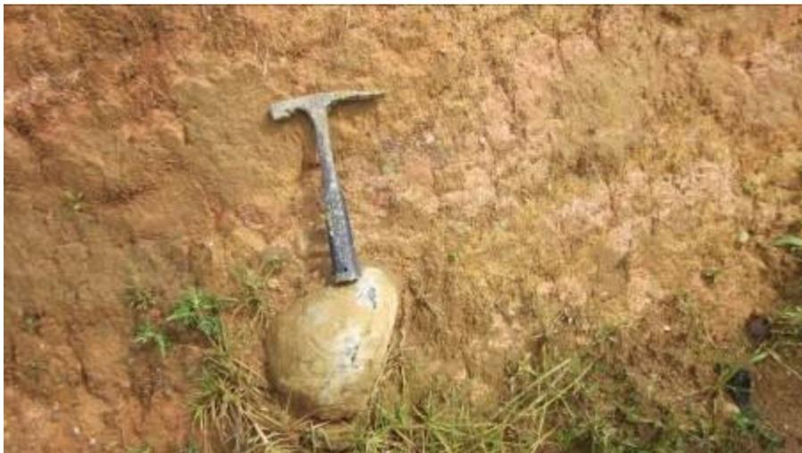
Figura 120. **El alto grado de meteorización del depósito de flujo de escombros de la Formación Casabianca le confiere una coloración rojiza y textura arcillosa.**
