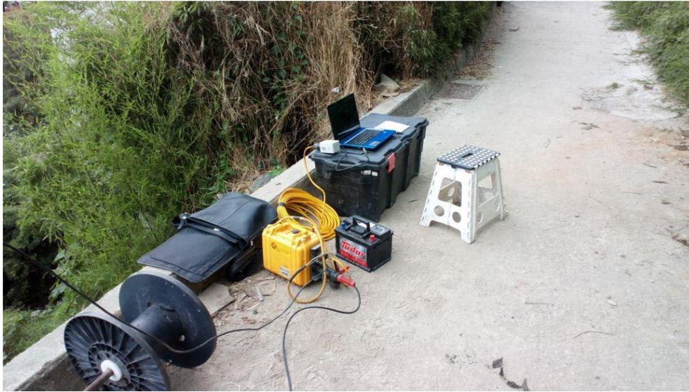
Figura 193. **Equipo adquisición de datos sísmicos LRS 5.**
