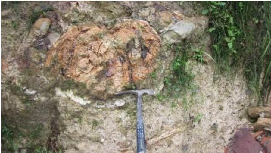
Figura 75. **Detalle de la Formación Casabianca en la base del talud objeto de estudio, en donde se tienen bloques de altamente meteorizados embebidos en matriz arcillosa de color habano.**
