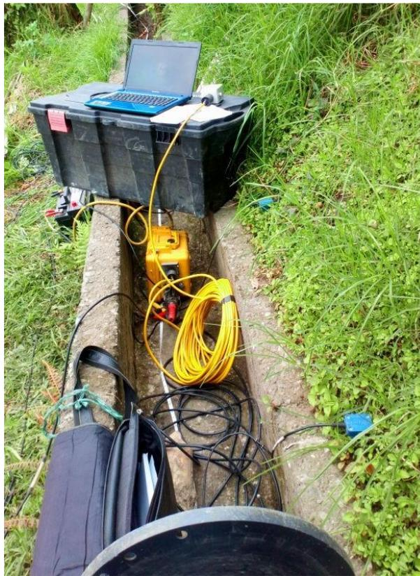
Figura 194. **Equipo adquisición de datos sísmicos LRS 6.**
