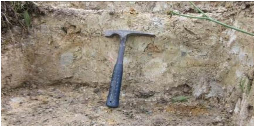
Figura 103. **El depósito de flujo de escombros de la Formación Casabianca se presenta muy alterado en el área del Sitio 3. Apenas se alcanzan a apreciar los clastos que lo constituyen.**
