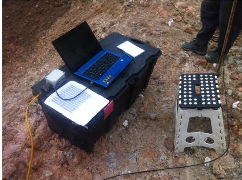
Figura 192. **Equipo adquisición de datos sísmicos LRS 3 y 4.**
