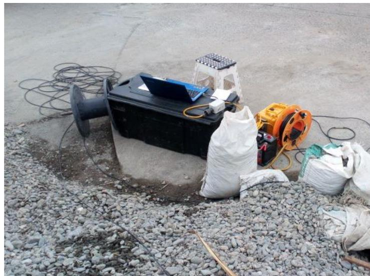
Figura 196. **Equipo adquisición de datos sísmicos LRS 8.**
