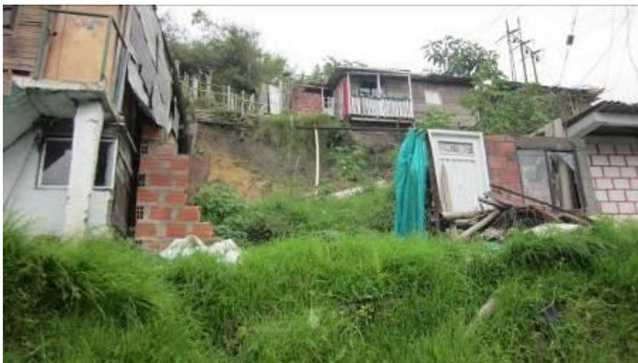
Figura 126. **Detalle de zonas con inclinaciones mayores o iguales a 30°, donde la pendiente es un factor desequilibrante en la estabilidad de la ladera.**
