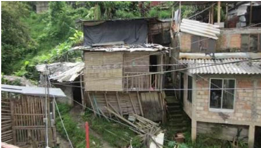
**Figura 100. Algunas viviendas presentan sistemas constructivos deficientes que incrementan su vulnerabilidad frente a la ocurrencia de un movimiento en masa.**
