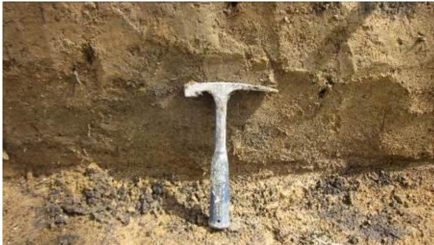
Figura 65. **Se tienen cenizas volcánicas como la formación superficial que conforma la zona.**
