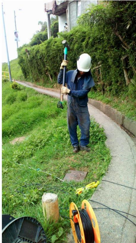
Figura 205. **Ensayo de refracción sísmica LRS 9**
