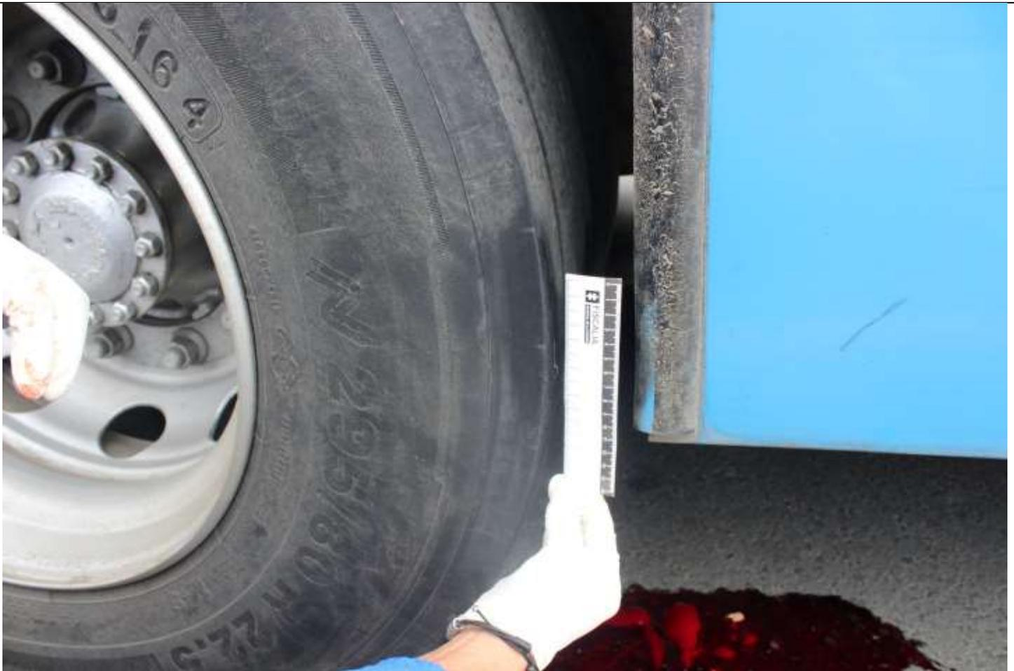
**IMAGEN No.17: PRIMER PLANO:** Fotografía judicial de fijación y verificación de daños sufridos en el siniestro en la **Evidencia No.2:** Vehículo tipo bus de placas **VCS-572** observando: Huella de limpieza sobre la llanta trasera derecha externa y sobre el faldon parte inferior.
