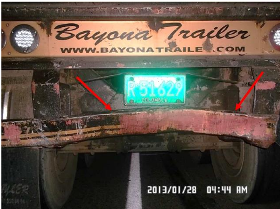
Imagen No.13: registro del día de los hechos, extraído de los informes suministrados, donde se observa la deformación residual de la defensa trasera del semirremolque, desplazamiento semicurvo hacia el interior con mayor compromiso directo del tercio medio y derecho.
