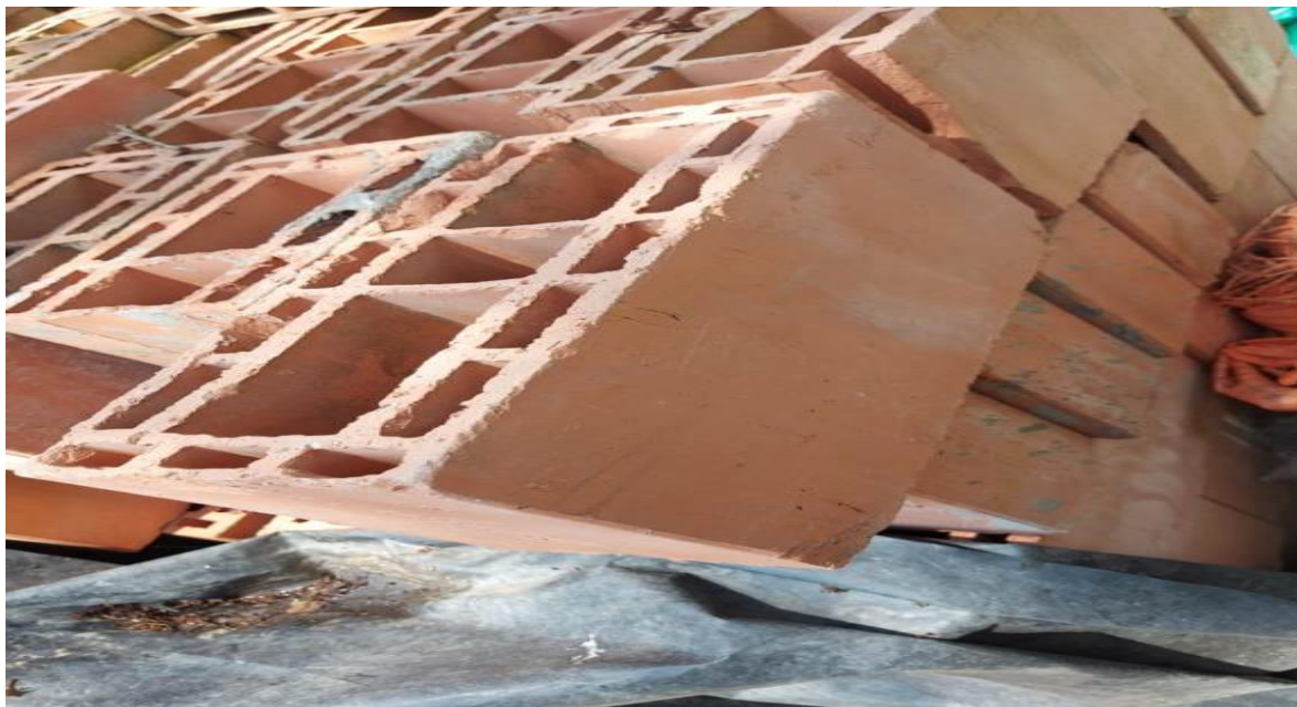
Figure 64 Almacenamiento de ladrillo estructural
