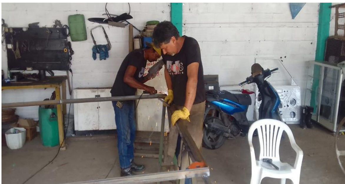
Figure 2 Soldando ángulos para cerramiento contra impacto
