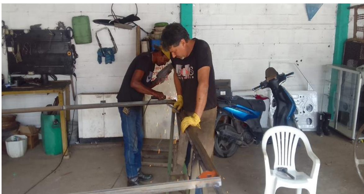
Figure 2 Soldando ángulos para cerramiento contra impacto
