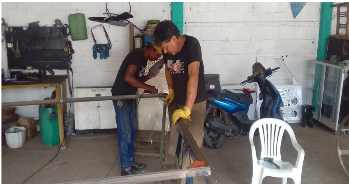
Figure 2 Soldando ángulos para cerramiento contra impacto
