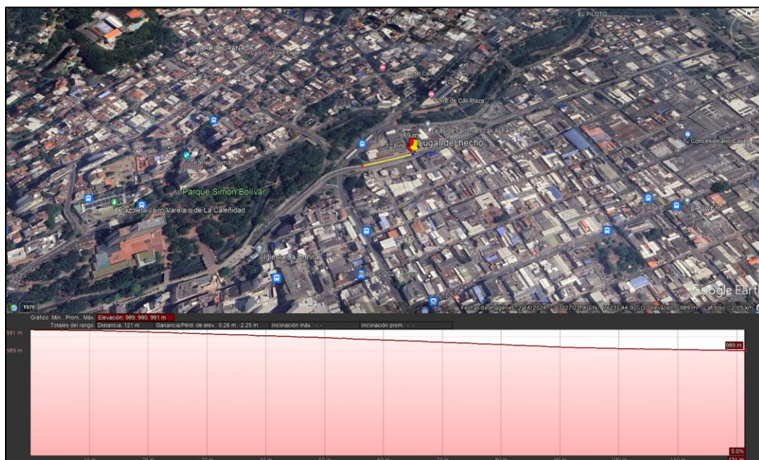
Figura N° 3: pendiente descendente en los 100 m antes del sitio del hecho, en el sentido de circulación del camión compactador (Vehículo #1). Imagen capturada de Google Earth®.
