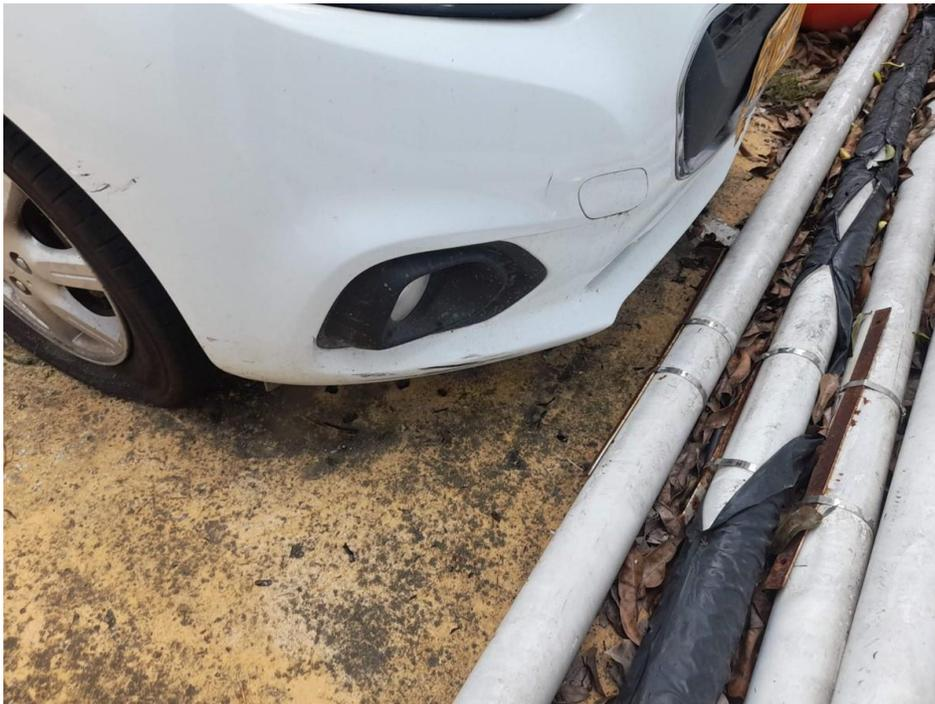
**Fotografía No. 9 Primer Plano:** En estas fotografías se aprecia polifragmentación de la unidad de luz derecha y huella de paso en el vértice anterior derecho del paragolpes.
