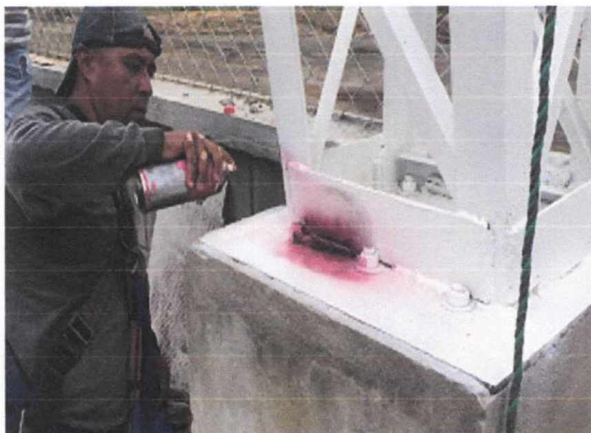
Foto No. 6. Prueba de tintas penetrantes
