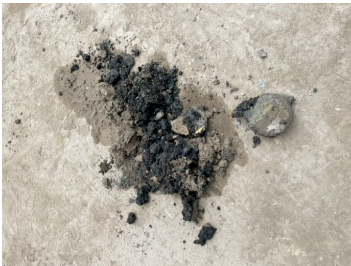
Material asfáltico sacado del sifón tapado
