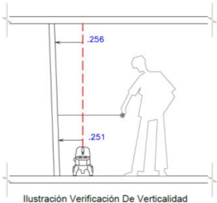
Ilustración 10 EQUIPO PARA MEDIR VERTICALIDAD DE MUROS INGESTRUCTURAS LTDA
