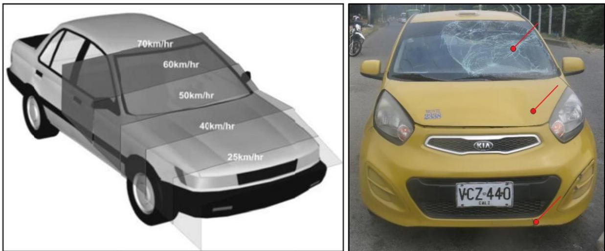
**Figura N° 17:** relación de velocidad de impacto y localización de daños en el frente del vehículo en atropellos con envoltura hacia atrás.
