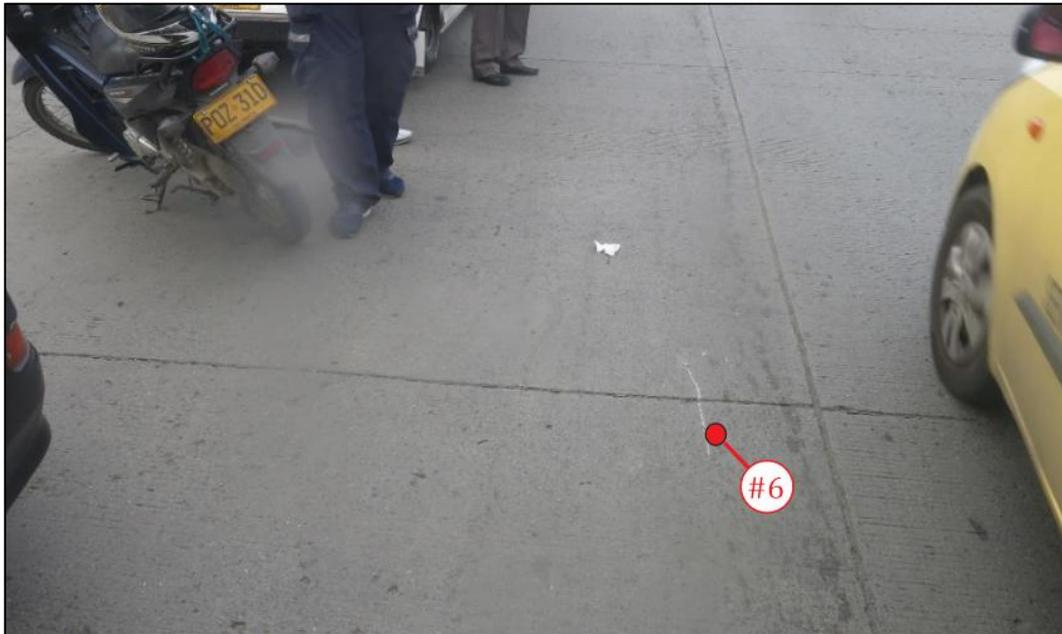
Figura N° 13: marca de arrastre metálico. Imagen No06 del Documento N°2.
