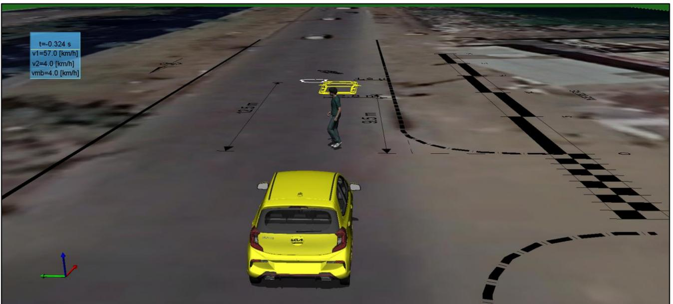
Figura N° 22: aproximación del vehículo Kia Picanto al área de colisión con cruce del peatón de derecha a izquierda.
