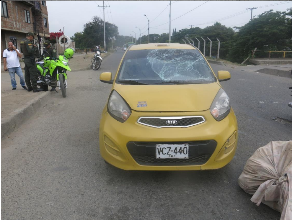
IMAGEN No. 07 Fijación fotográfica del vehículo tipo taxi de placa VCZ440 donde se observa el punto de impacto del vehículo al lateral izquierdo del para brisas delantero lo cual indica que el peatón pasaba la vía de occidente a oriente por la calzada de la calle 73.
