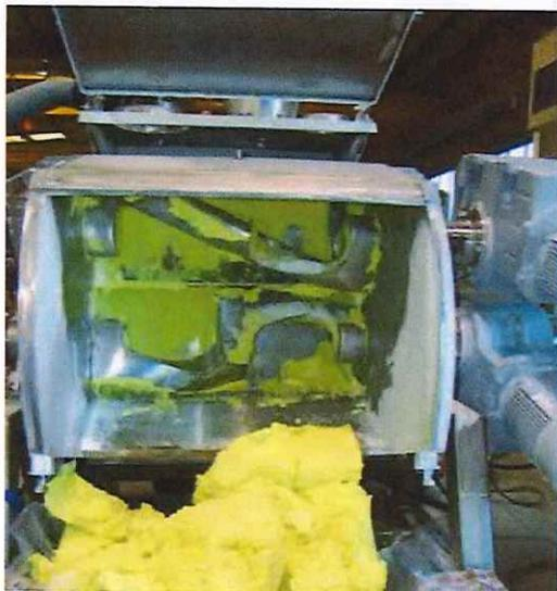
Se preparaban lotes de chicles de 250 a 450 Kg se sacaba del mezclador de forma manual hacia un carro transportador y luego se picaba por fracciones, de forma repetitiva, peso entre 15 kg y 20 kg
