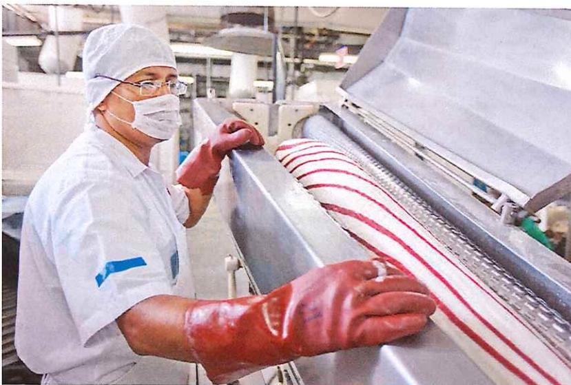
se debía revolver en una mesa y un mezclador manual las materias primas, peso aprox caramelo 60 kg, se fraccionaba en 2 partes para luego cargarlo e ingresarlo al extruder, esta actividad se repetia durante todo el turno
