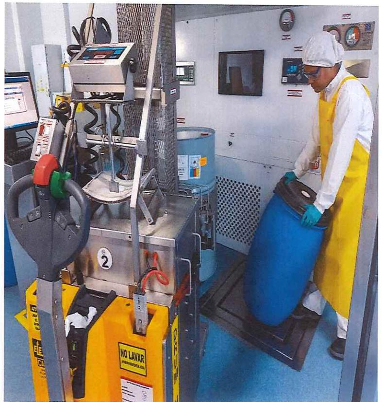
Se ladeaba y giraba la tina despues del proceso de pesaje, peso entre 50 kg a 220 kg
