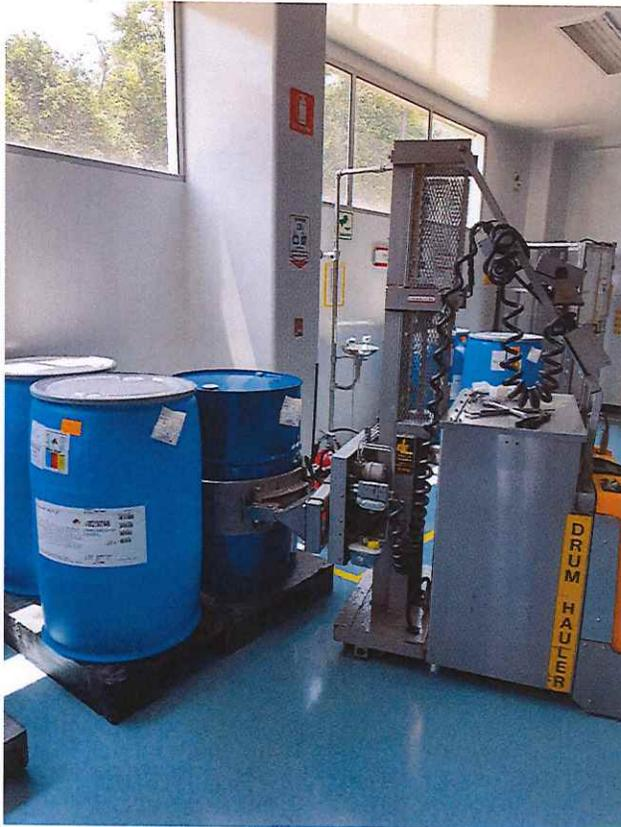
Empuje de tina de forma manual para poder agarrarlo con el elevador de tinas peso entre 220 kg y 275 kg
