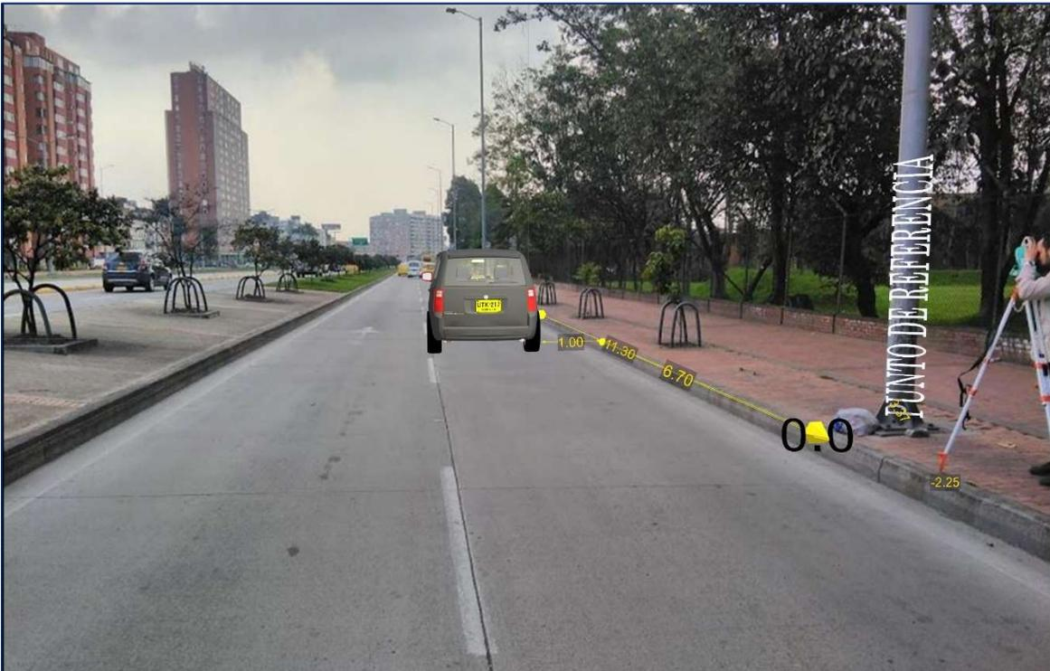
**IMAGEN 3.** Imagen en 3D, tomada del software de reconstrucción Edge FX. Donde se observan la posición final del vehículo de acuerdo a la fijación topográfica adelantada por la policía de tránsito.
