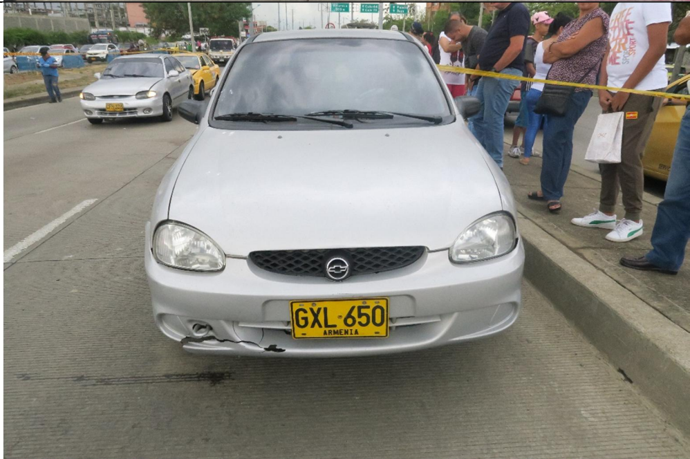
IMAGEN No. 36 Fijación fotográfica primer plano de la escena tomada en sentido occidente – oriente del vehículo de placas GXL650, donde se puede observar daños en el bomper delantero costado derecho, lugar donde impacta con la víctima.
