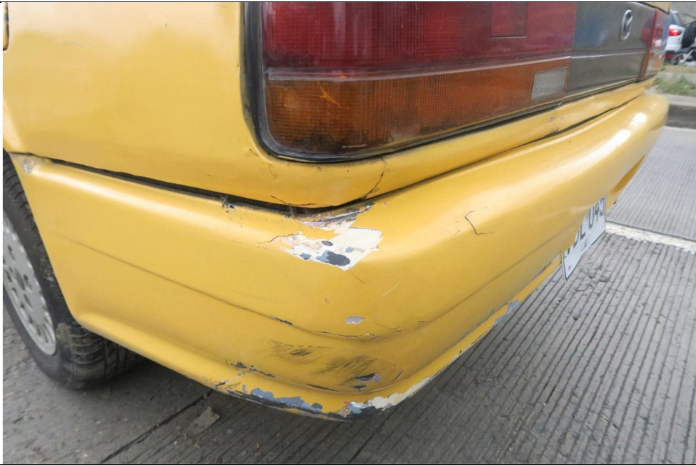
IMAGEN No. 21 Fijación fotográfica primerísimo plano del vehículo tipo taxi de placas VBL045, se observa el bumper trasero lado izquierdo, donde colisiono la motocicleta de placas NZJ52B.
