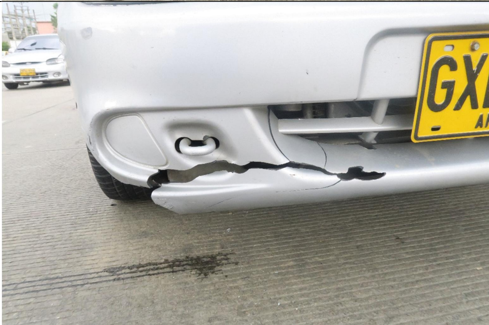
IMAGEN No. 39 Fijación fotográfica primer plano de la escena tomada en sentido occidente- oriente del vehículo de placas GXL650, donde se puede observar el daño en el bomper delantero lado derecho debido al impacto con la víctima..
