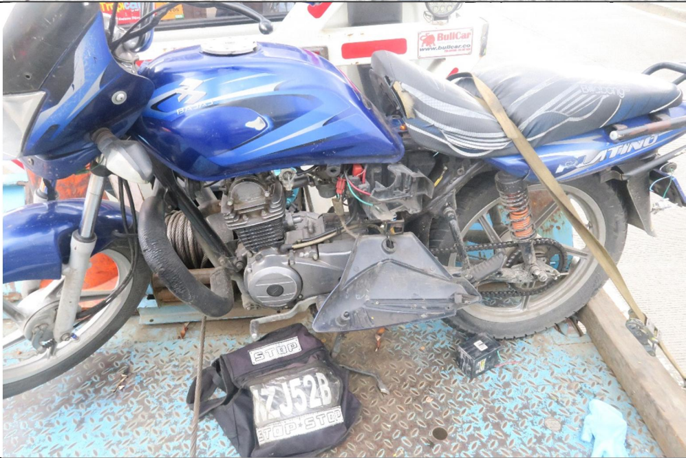
IMAGEN No. 28 Fijación fotográfica primer plano de la motocicleta de placas NZJ52B, se observan daños parte izquierda, sillín, defensa, porta batería, tapa lateral izquierda.
