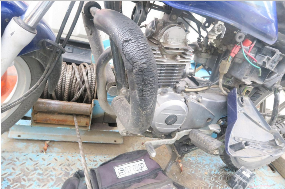
IMAGEN No. 29 Fijación fotográfica primerísimo plano de la motocicleta de placas NZJ52B, se observa daños tapa lateral izquierda, defensa.
