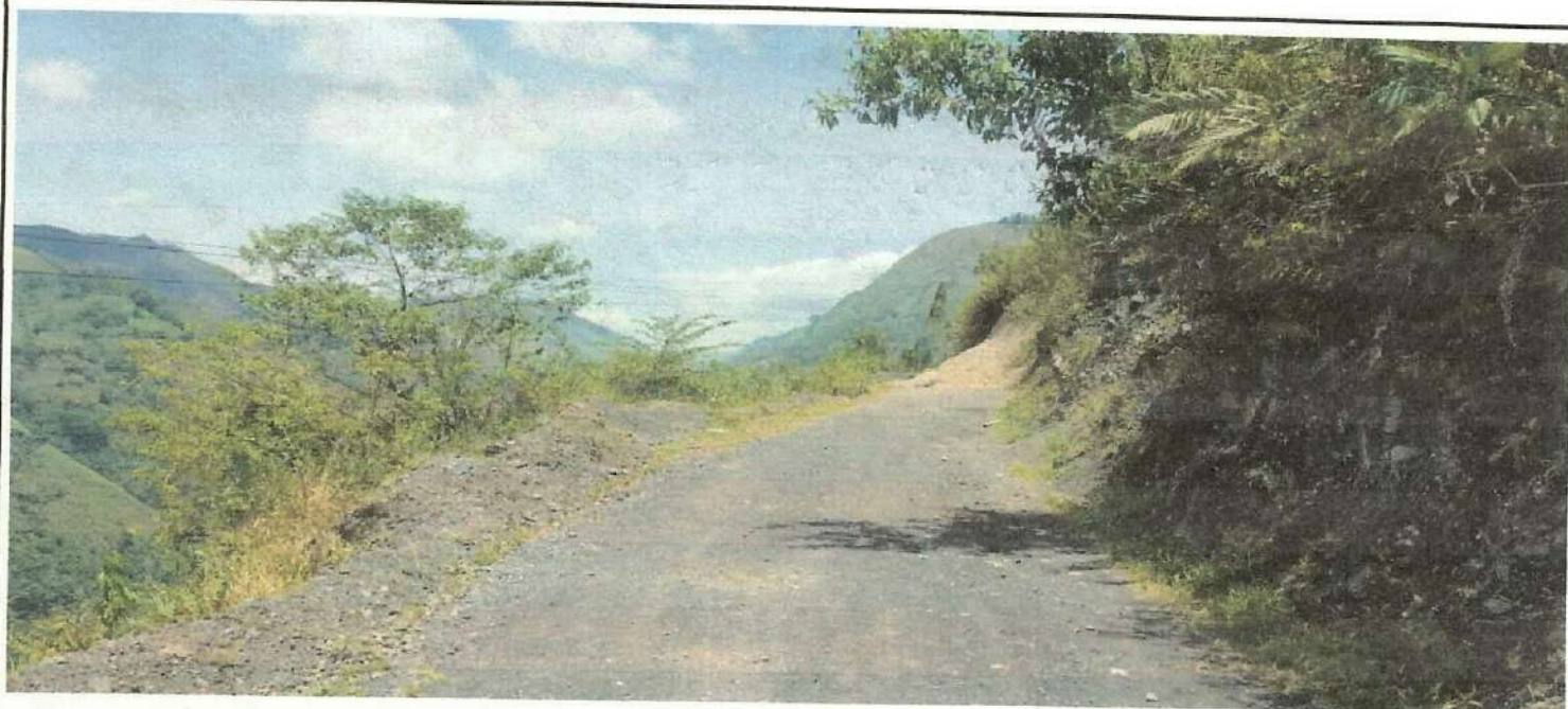
FOTOGRAFIA No 2 whatsapp image-2017-08-20 at 18.33.42 (1)jpeg PLANO GENERAL: Donde se aprecia el diseño geométrico de la vía por donde transitaba el vehículo No 1 motocicleta, sin línea de borde o carril, con zona verde a la izquierda y zona verde ha costado derecho, semi curva, plano, doble sentido circulación, material tierra, se puede observar de igual manera las condiciones climáticas como es tiempo seco, con iluminación natural; al fondo se puede observar un barranco donde finaliza la vía en el sentido Dindal la palma. (Fotografía tomada en sentido vial Guaduas-Villeta).
