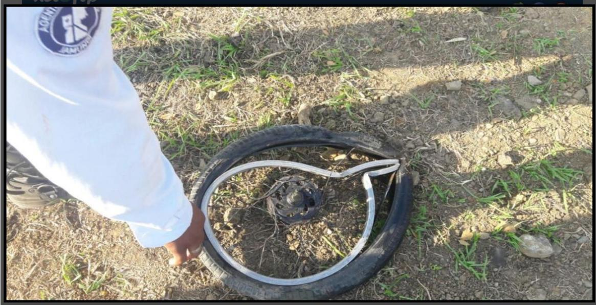
**FOTOGRAFIA N° 5:** Se observa eje delantero del tercer vehículo N°2 bicicleta, doblado y con deformaciones derivado del fuerte impacto con objeto fijo.
