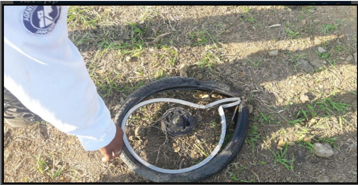
FOTOGRAFIA N° 5: Se observa eje delantero del tercero vehículo N°2 bicicleta, doblado y con deformaciones derivado del fuerte impacto con objeto fijo.
