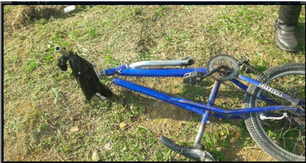
**FOTOGRAFIA N° 4:** Se observa el tercer vehículo N°2 bicicleta con número de marco **F342396** de color azul, presenta impacto en vista frontal con ruptura de marco anterior y desprendimiento del eje delantero.
