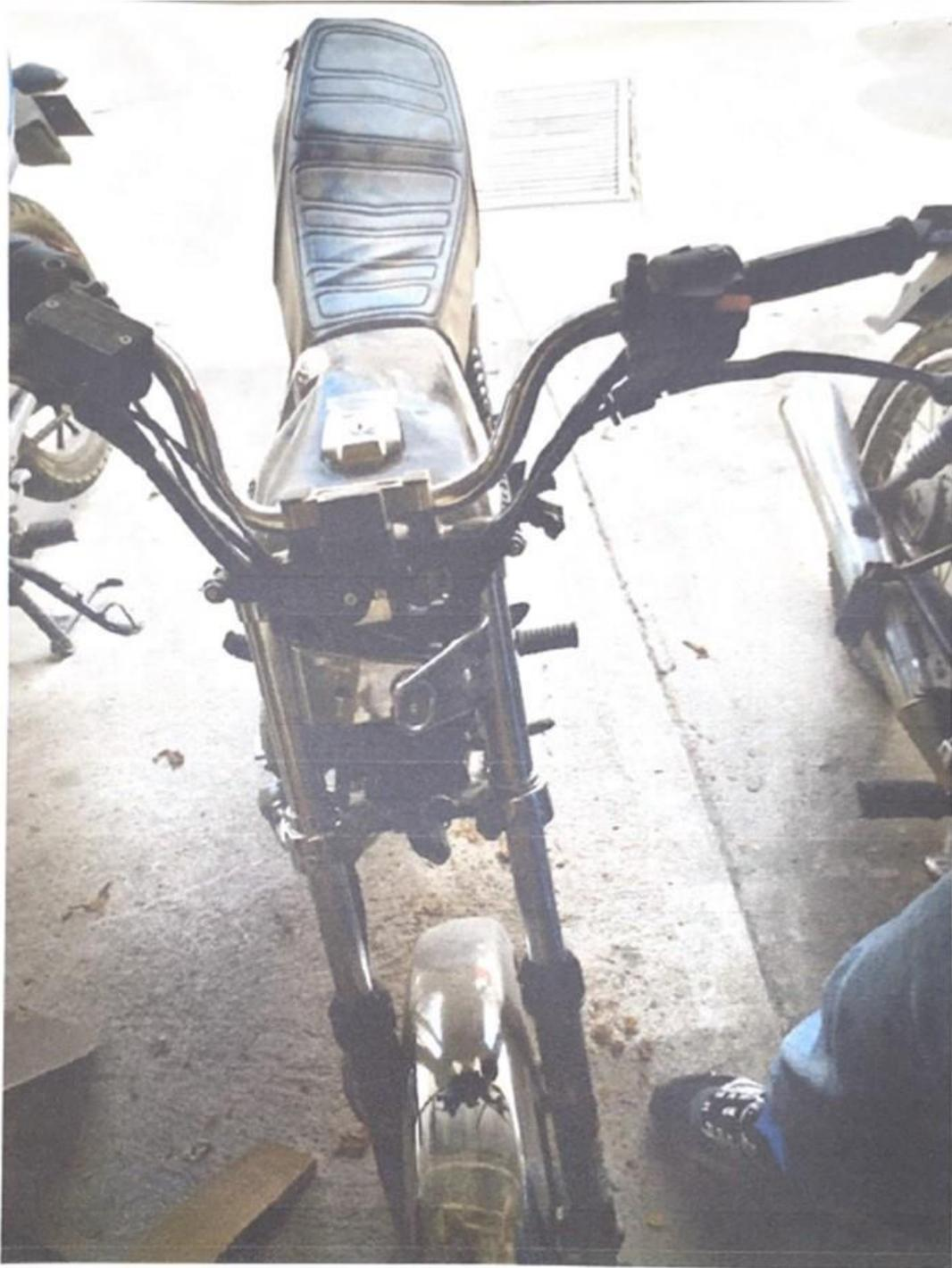
**Fotografía No. 7 Plano Medio:** En esta fotografía se observa el estado final del vehículo, el cual presenta daños en su zona anterior, afectando la unida de luz.
