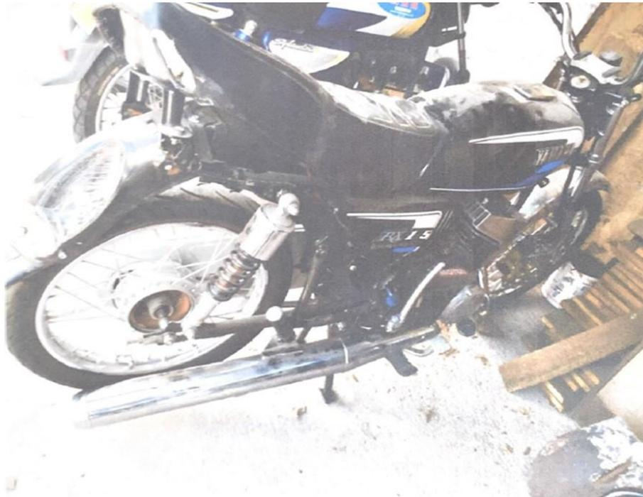
**Fotografía No. 9 Plano Medio:** En estas fotografías se observa el daño en el costado derecho, afectando las tapas y en el costado derecho más hacia el tercio posterior el guardafangos.
