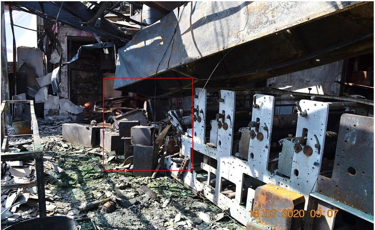
De acuerdo a la informado por el jefe técnico del área de impresión, en el módulo 1, unidad 2 se encontraba praimer (etanol), base solvente e inflamable necesaria para acondicionar el polipropileno para la impresión, lugar en donde se originó el fuego.
