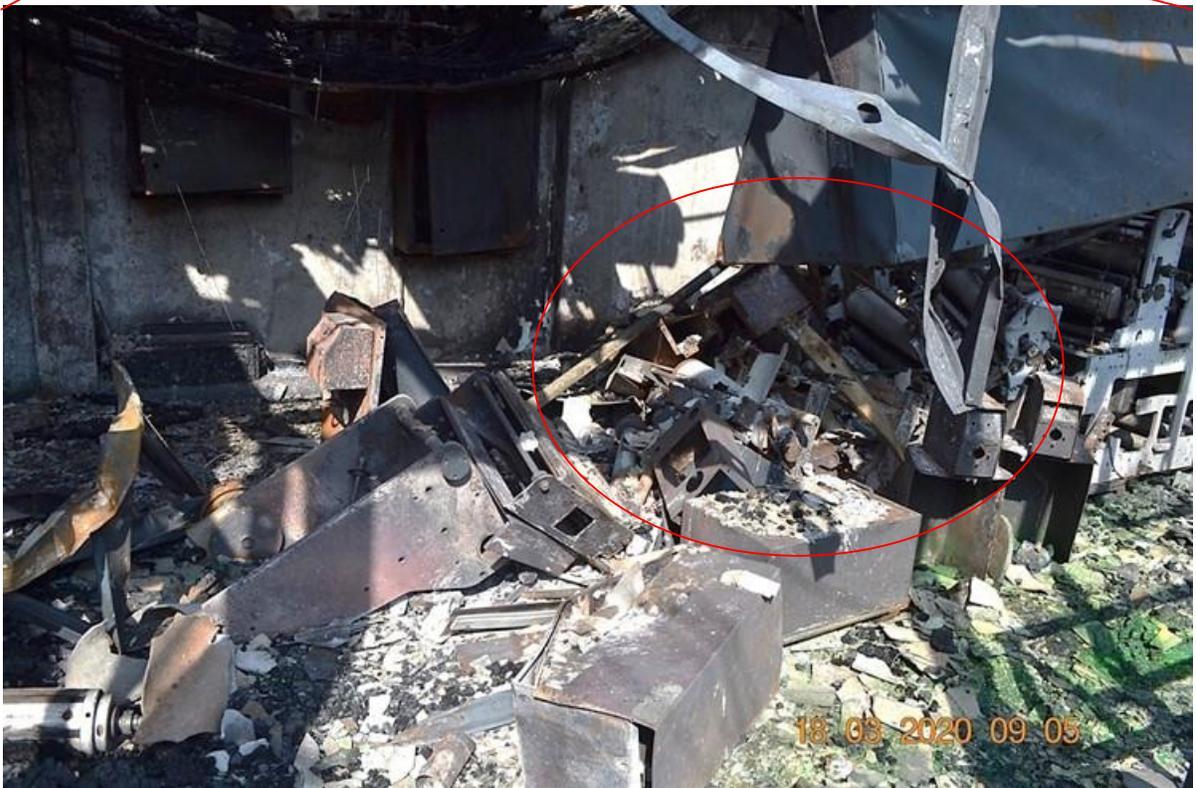
Sin embargo, se revisó el área de origen del incendio, pero el daño sobre los componentes no permitió identificar el mecanismo de ignición de los vapores.
