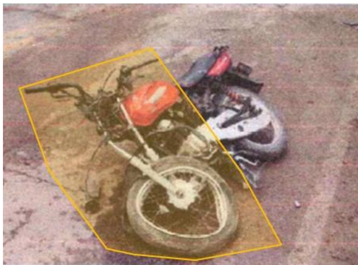
Imagen No.16 : En esta imagen se aprecia algunos de los daños en la Motocicleta hacia el tercio anterior.
