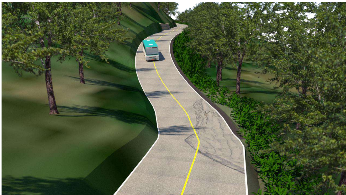
En esta imagen se observa la trayectoria del vehículo afiliado a la empresa Rápido Tambo "TRANSTAMBO" donde se aprecia que el vehículo microbús sobrepasa la línea central continua amarilla con las llantas del costado lateral izquierdo, se aprecia además el daño estructural de la vía en su costado derecho, en sentido Bolívar-El Bordo
