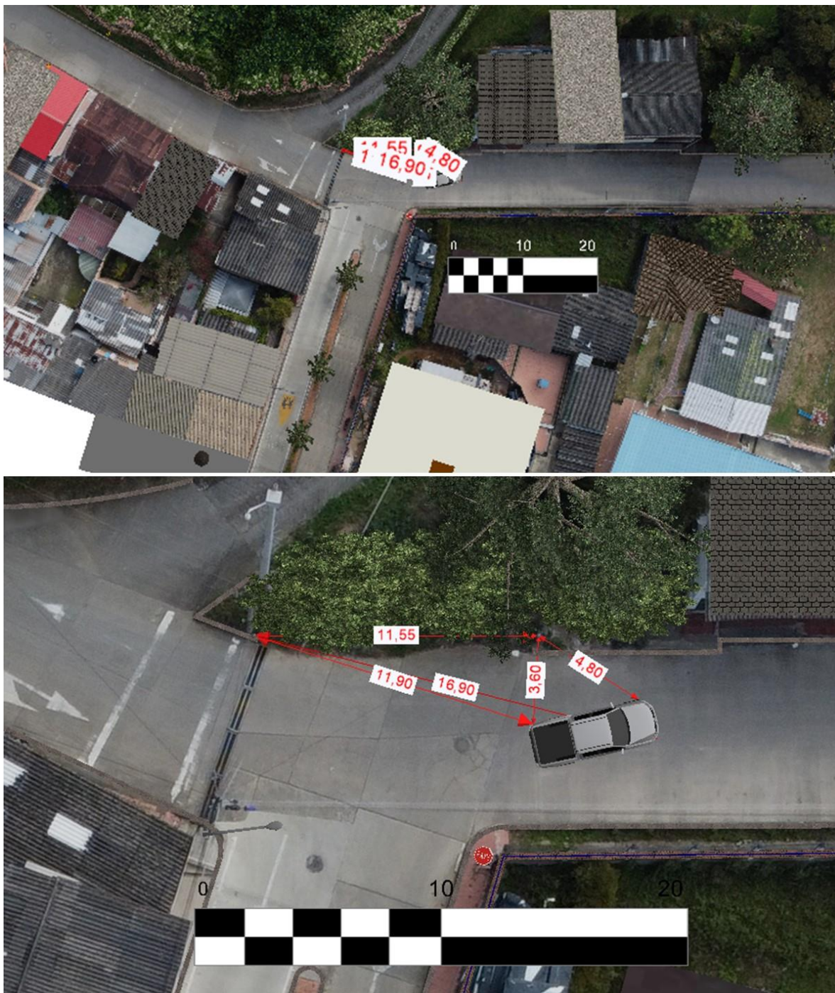
Imagen No. 8: En estas imágenes, vista en planta se observan las evidencias diagramadas en el croquis de la autoridad. Elaboración a escala en el software Trimble Forensics Reveal.
