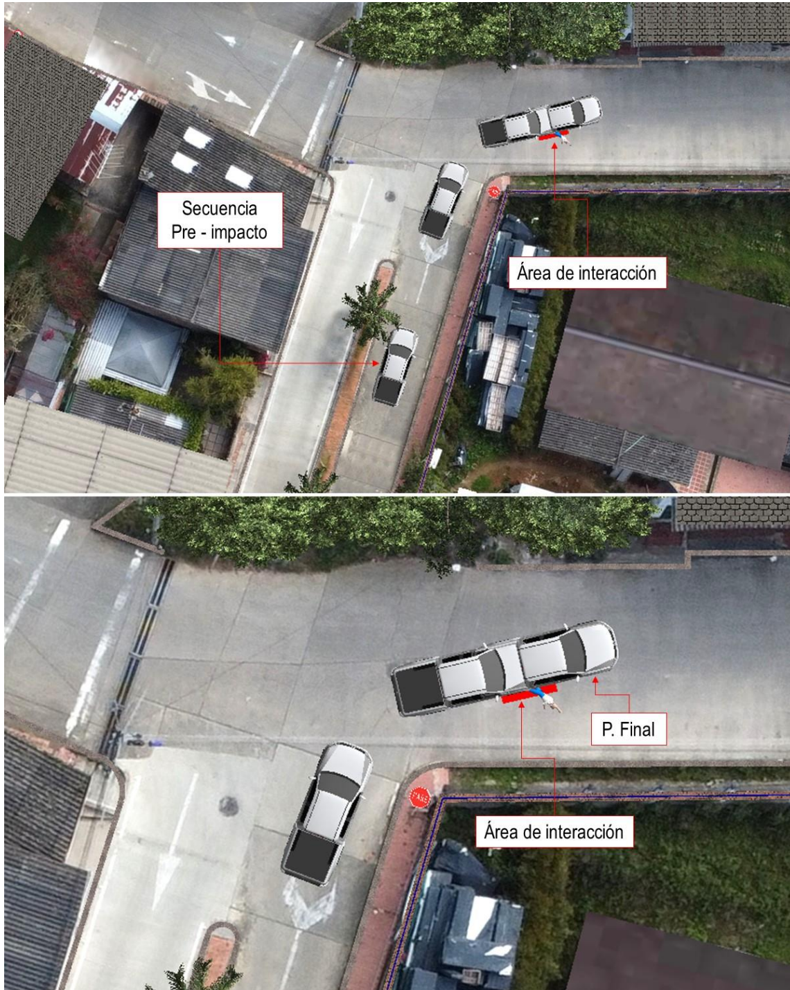
Imagen No. 20: En estas imágenes, vista en planta se aprecia la secuencia del siniestro, nótese el sentido de desplazamiento del vehículo y la posición relativa sobre la calzada.
