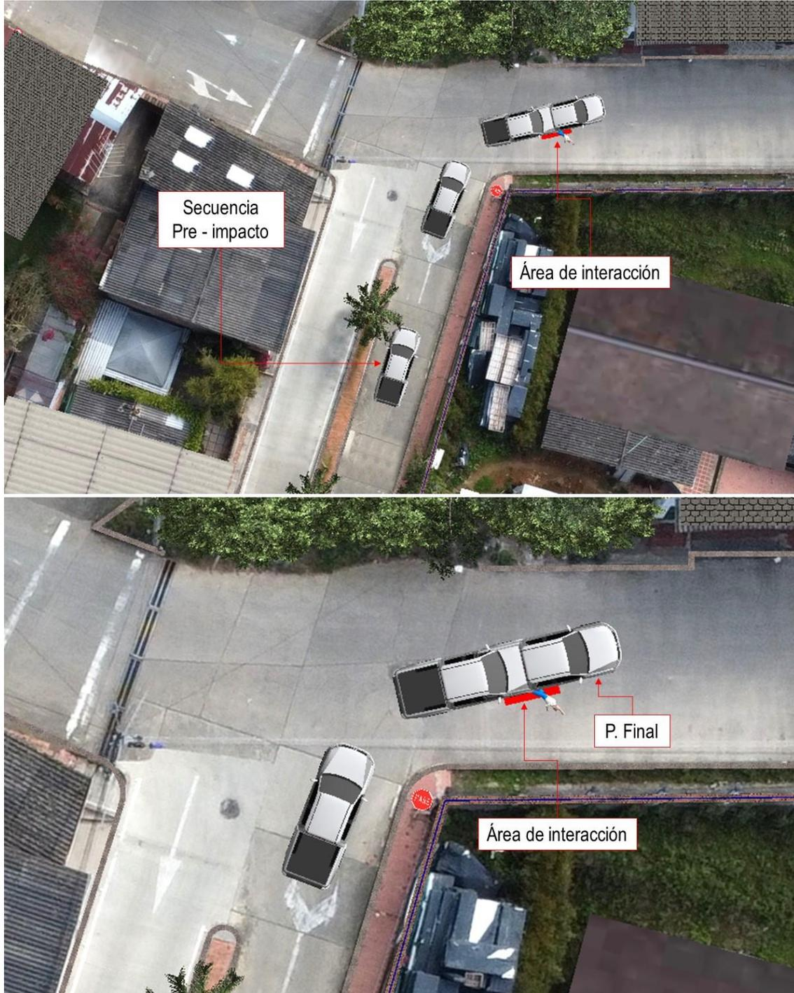
**Imagen No. 14:** En estas imágenes, vista en planta se aprecia la secuencia del siniestro, nótese el sentido de desplazamiento del vehículo y la posición relativa sobre la calzada.
