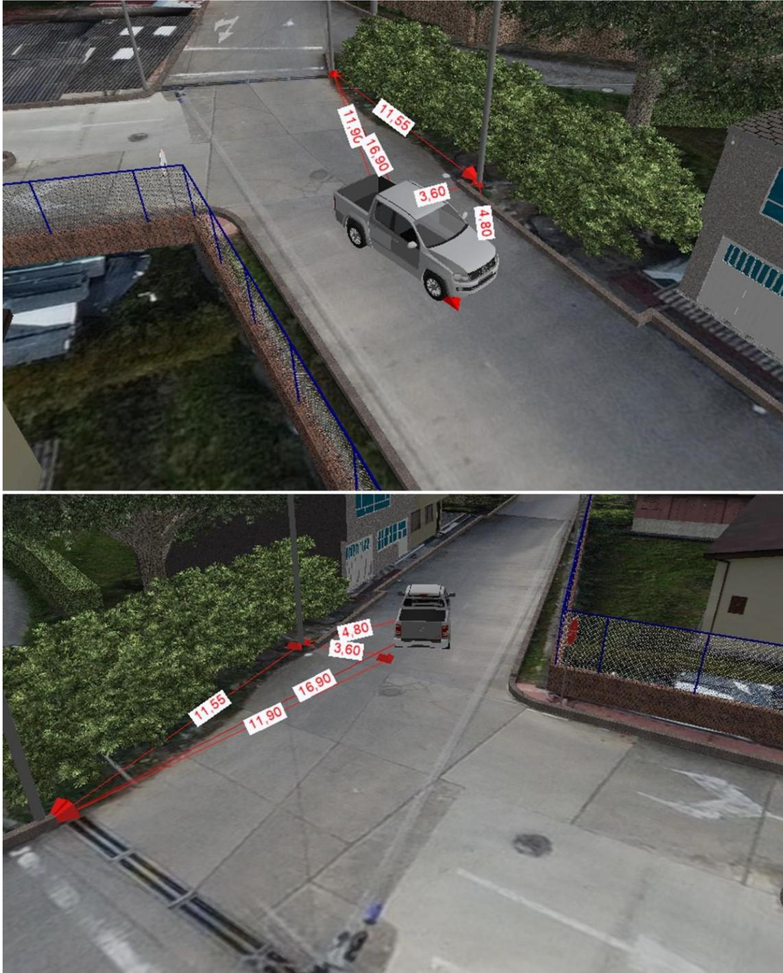
**Imagen No. 9:** En estas imágenes, vista en 3D se observan las evidencias diagramadas en el croquis de la autoridad. Elaboración a escala en el software Trimble Forensics Reveal.
