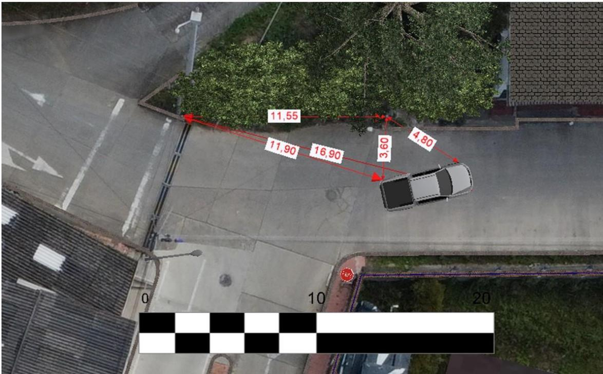
**Imagen No. 8:** En estas imágenes, vista en planta se observan las evidencias diagramadas en el croquis de la autoridad. Elaboración a escala en el software Trimble Forensics Reveal.
