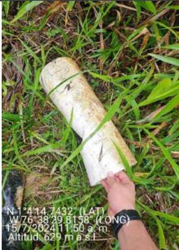
**Imagen 13** Tubo con abolladura reemplazado por la Alcaldía.
