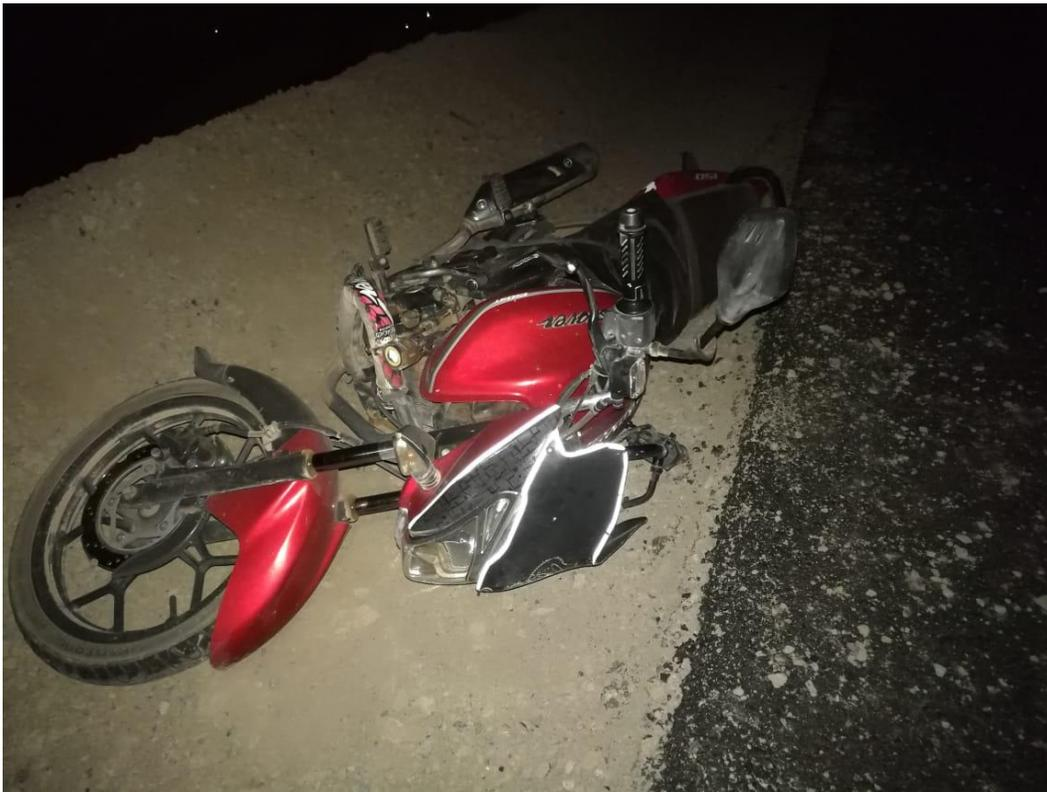
**IMAGEN No. 04 PLANO MEDIO:** imagen donde se observa los daños ocasionados en la caída de la motocicleta con respecto a la colisión contra el piso.
