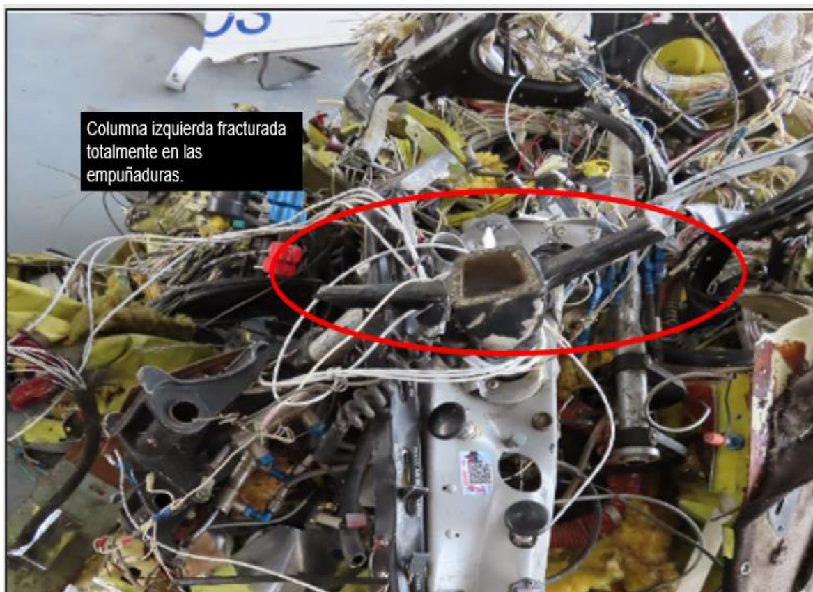
Fotografía No. 10: Columna izquierda de mando fracturada.
