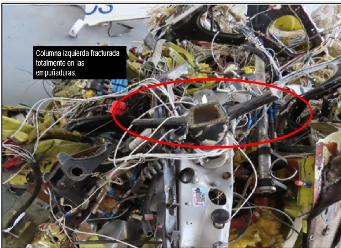
Fotografía No. 10: Columna izquierda de mando fracturada.
