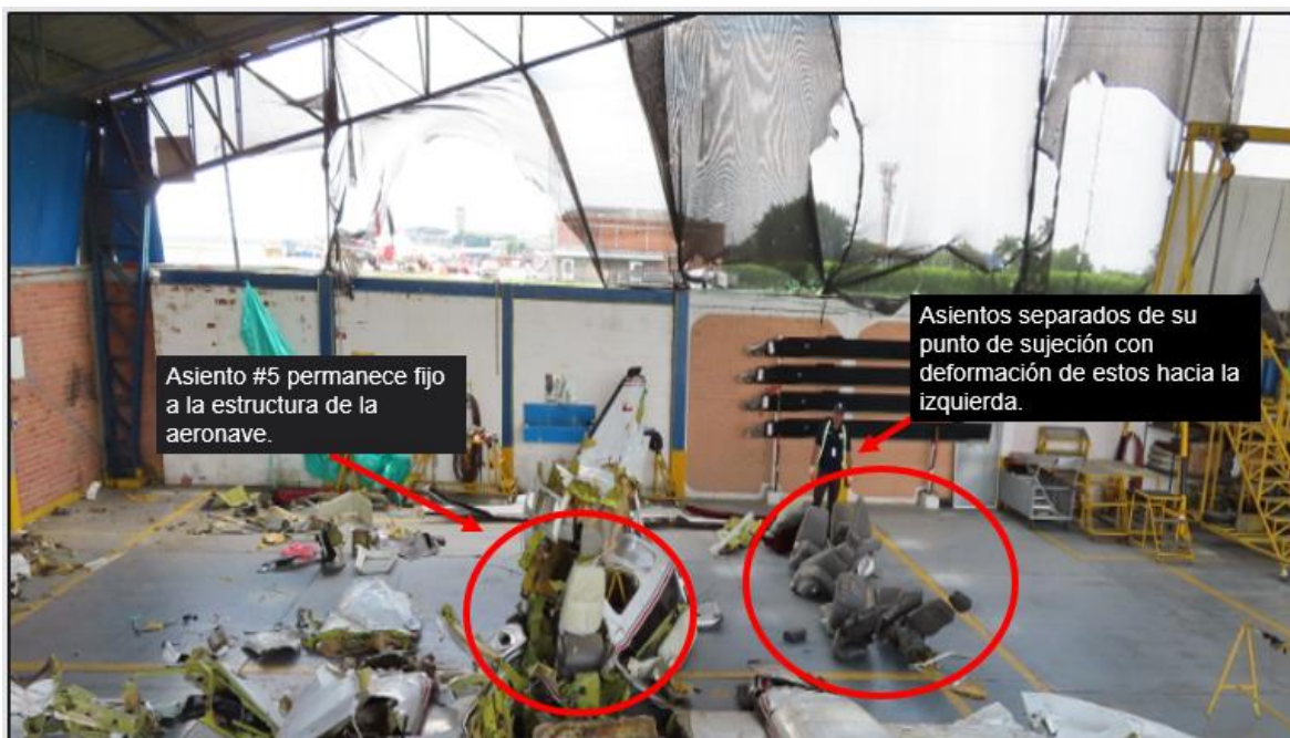
Fotografía No. 9: Posición de los asientos de Pilotos y pasajeros con deformación hacia la izquierda.
