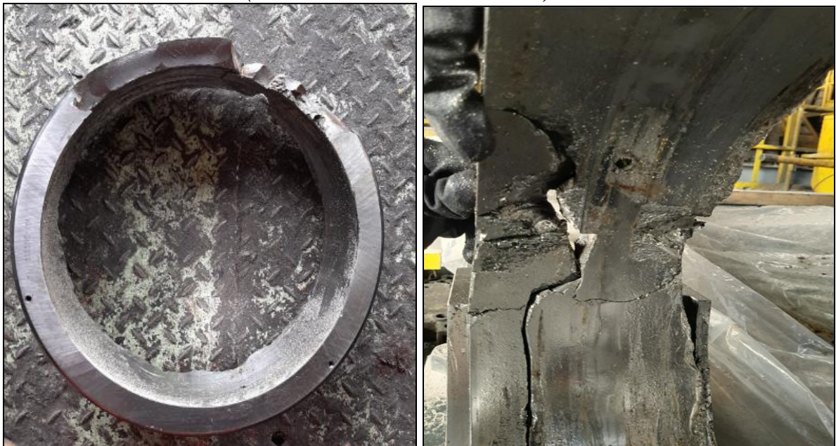
Pista exterior fracturada
