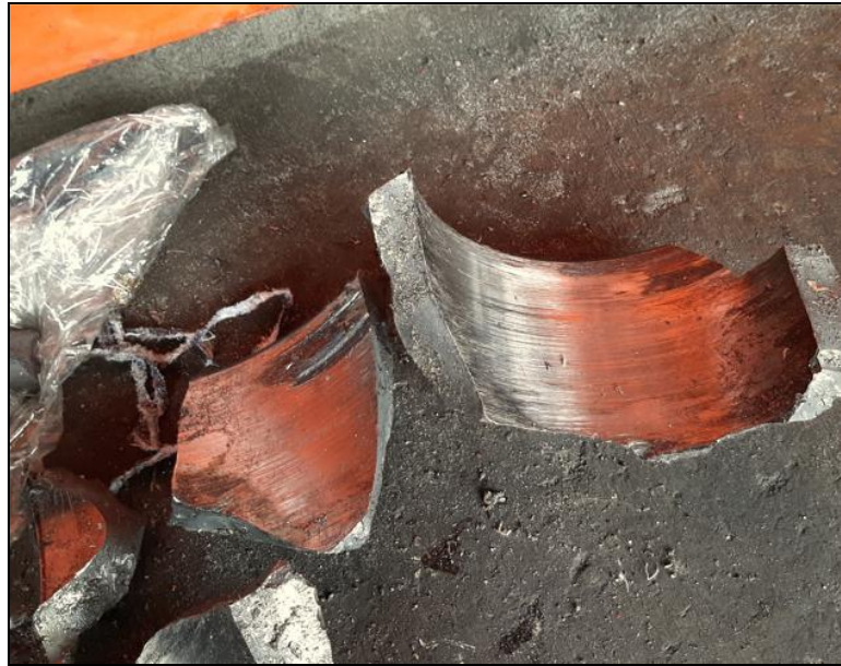
Pista interior Fracturada
