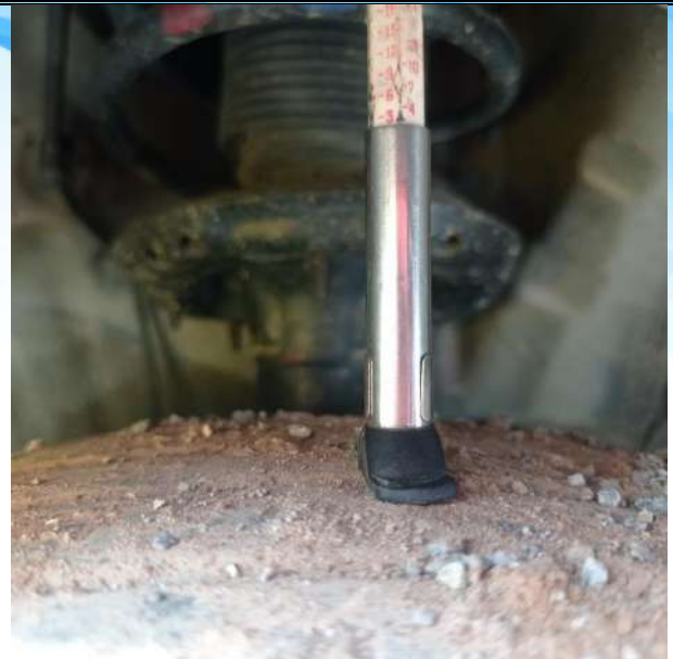
fotografía número 74 en primer plano: en esta imagen se observa el labrado de la llanta anterior derecha del vehículo automóvil de placas GYQ-681 : llanta tipo neumática, no apta para ser transitada, daños que fueron causados mientras el vehículo estuvo hurtado
