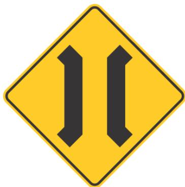
Esta señal se emplea para advertir a los usuarios sobre la proximidad a un puente, alcantarilla u obra de similares características, cuyo ancho es inferior al ancho de corona de la vía. Debe complementarse con la señal reglamentaria SR-33 ANCHO MÁXIMO PERMITIDO, cuando este sea inferior a 3/4 del ancho de la calzada. El ancho total disponible considera la calzada y la berma, excluyendo andén y espacios destinados a la circulación y tránsito de bicicletas u otros usuarios no motorizados.
