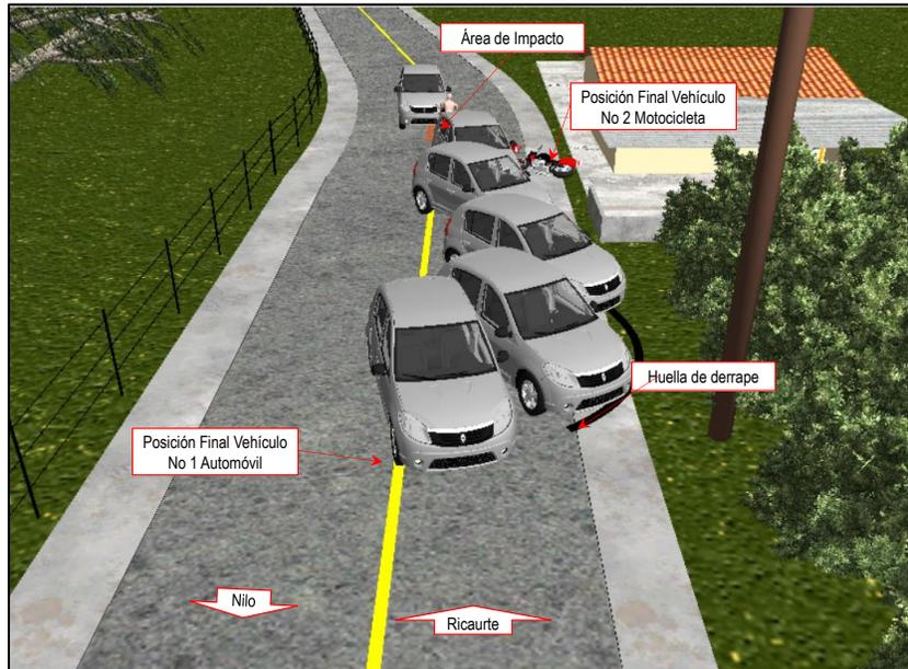
**Imagen No. 22:** En esta imagen, vista en planta se observa la secuencia del accidente, nótese el sentido de desplazamiento de los vehículos, el área de impacto de color naranja y sus desplazamientos hasta sus posiciones finales. Elaborada en el software Trimble Forensic Reveal.
