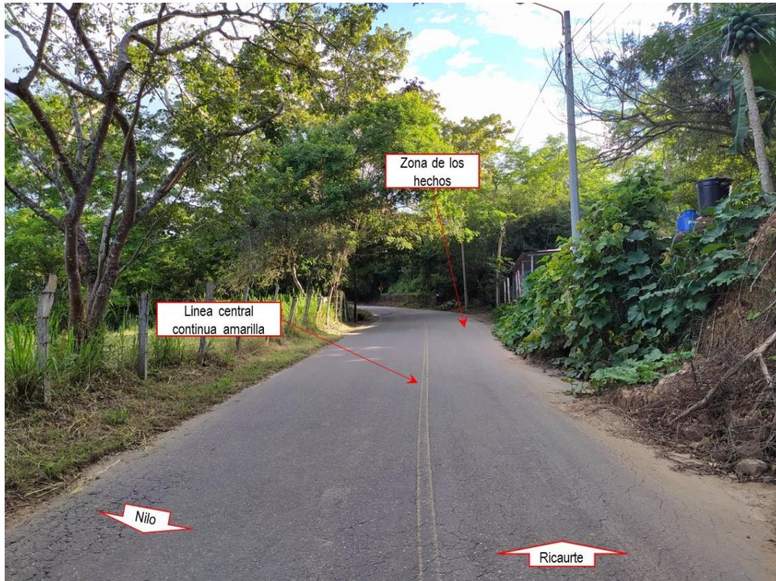
**Fotografía No.2 Plano General:** fotografía tomada en sentido Nilo - Ricaurte, donde se observan las características generales del tramo de vía curva, pendiente, estado bueno, doble sentido de circulación, sin demarcación horizontal línea central continua amarilla y sin señalización vertical. En este sentido se desplazaba el Vehículo No 2 MOTOCICLETA.
