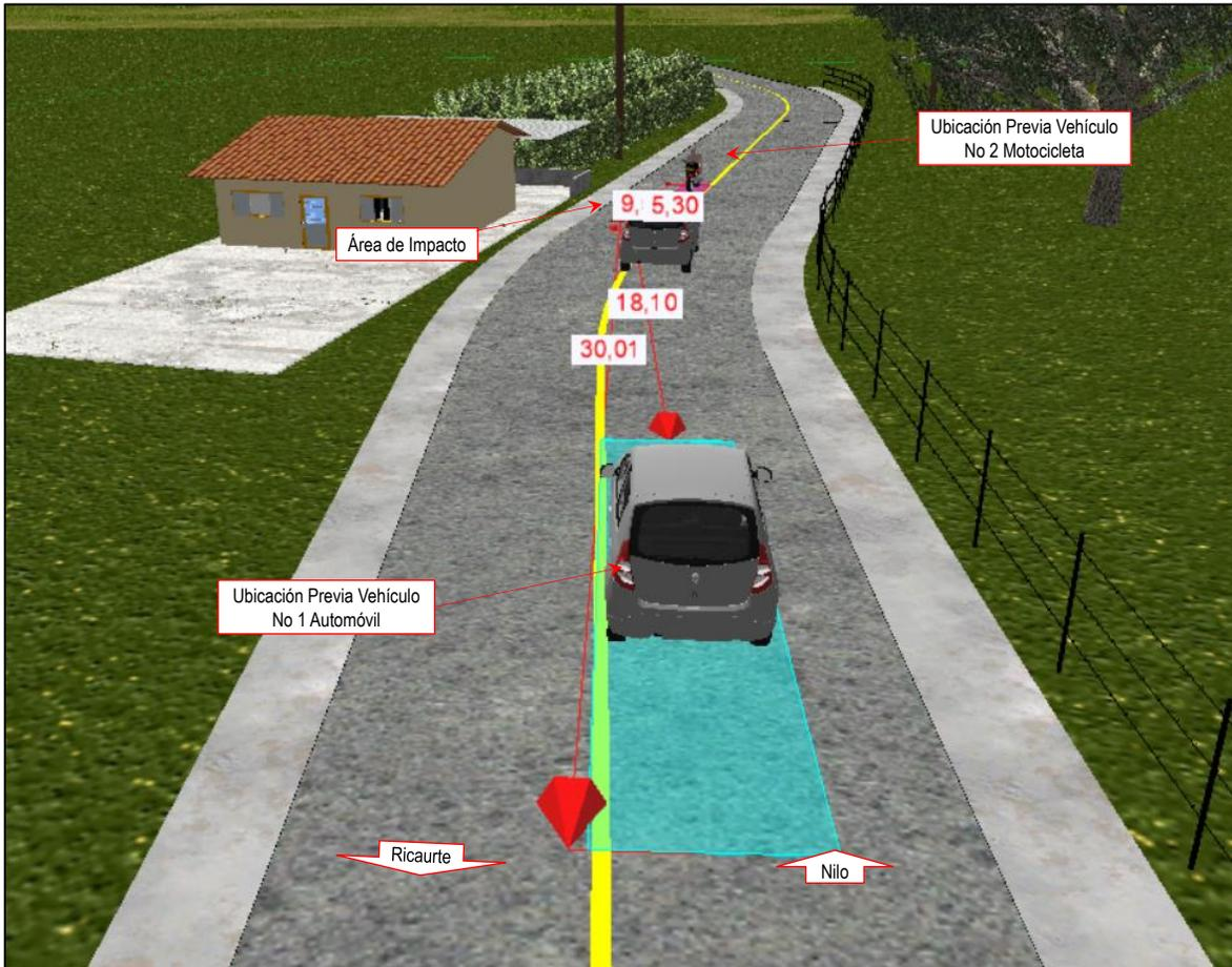
**Imagen No.30:** En esta imagen, se observa el área de ubicación relativa entre los vehículos involucrados 1,5s y 2,0s antes del área de impacto. Elaborada en el software Trimble Forensic Reveal.
