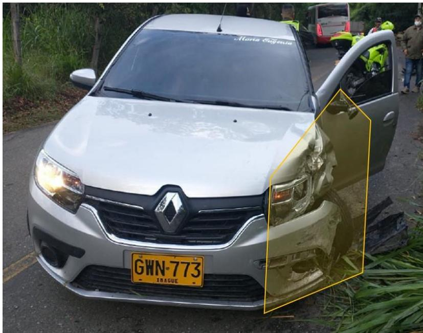
**Fotografía No.9:** En esta imagen se observa los daños en el vehículo en donde se aprecia daños guardafango izquierdo, farola izquierda, capó, paragolpes delantero.
