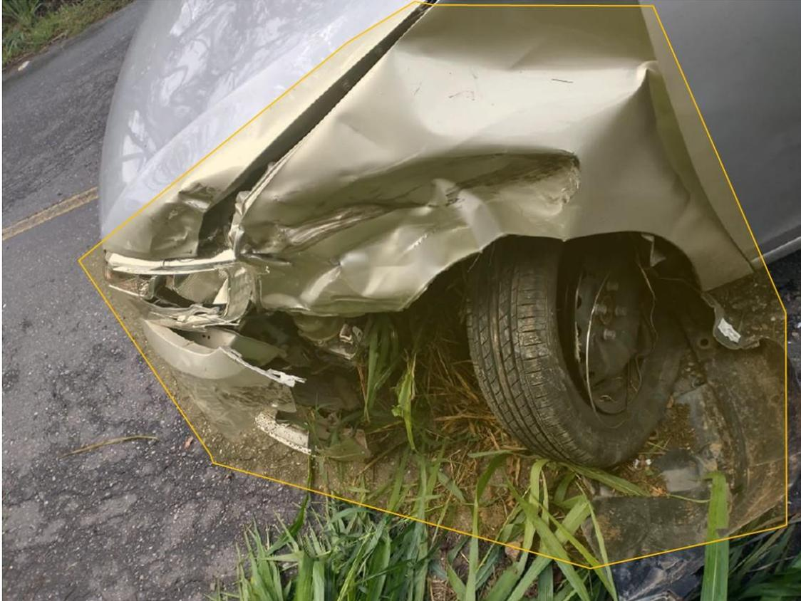
**Fotografía No.10:** En esta imagen se observa los daños en el vehículo en donde se aprecia daños guardafango izquierdo, farola izquierda, capó, paragolpes delantero.
