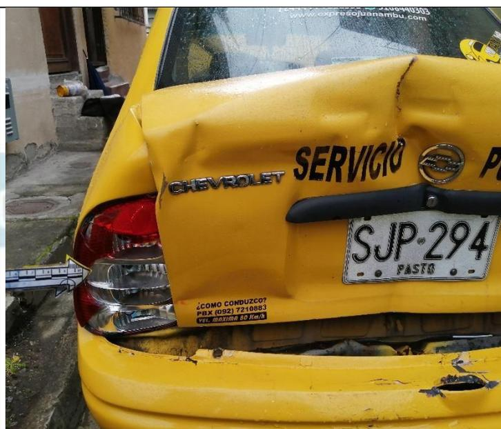
IMG. – 153145. Primer plano tercio posterior costado izquierdo parte inferior, luna stop y direccionales, averiada por rotura, del vehículo de placas SJP-294.
