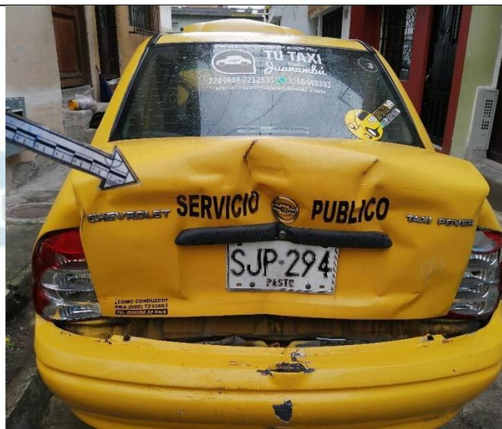
IMG. – 152706. Primer plano tercio posterior superior, tapa baúl arrugada y averiada por abolladura, del vehículo de placas SJP-294.
