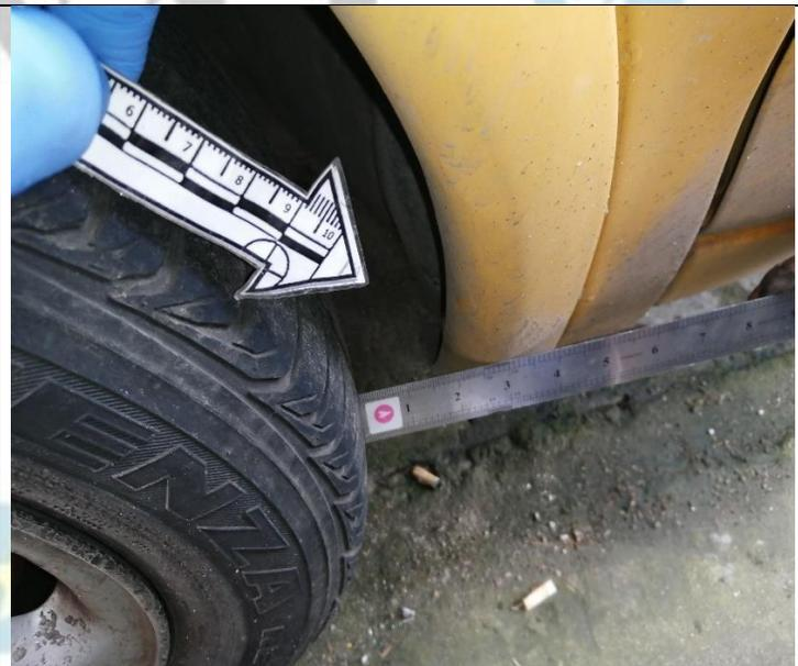
IMG. – 153920. Primer plano, tercio anterior izquierdo, unidad de rodadura se observa desviación en la convergencia por el impacto y el esfuerzo que se generó por el impacto, en el sistema de dirección (suspensión), del vehículo de placas SJP-294.
