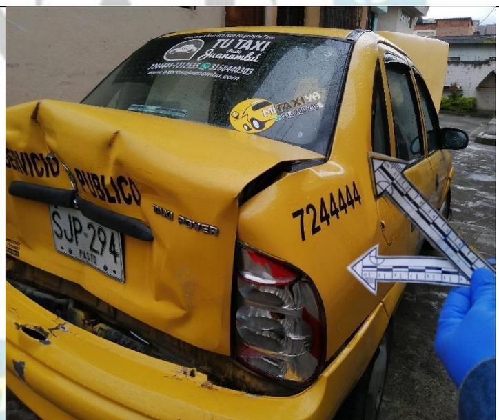
IMG. – 153116. Primer plano tercio posterior costado derecho parte superior, nave y paral averiados por deformación y abolladuras, del vehículo de placas SJP-294.
