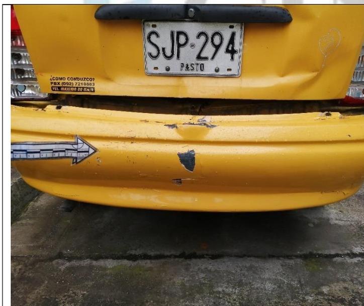
IMG. – 153047. Primer plano tercio posterior parte inferior, bómper averiado por rotura y desprendimiento parcial, del vehículo de placas SJP-294.
