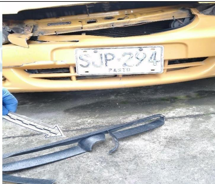
IMG. – 152030. Primer plano, parte frontal medio inferior, persiana averiada por rotura con desprendimiento total, del vehículo de placas SJP-294.
