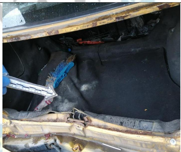
IMG. – 153318. Primer plano tercio posterior parte interna, carrocería baúl, averiada por abolladura, arqueamiento, rotura y arrugamiento, del vehículo de placas SJP-294.
