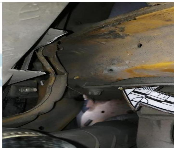
IMG. – 152546. Primer plano, tercio anterior costado derecho parte inferior, se evidencia desviación en relación hacia el motor generada por el impacto, del vehículo de placas SJP-294.
