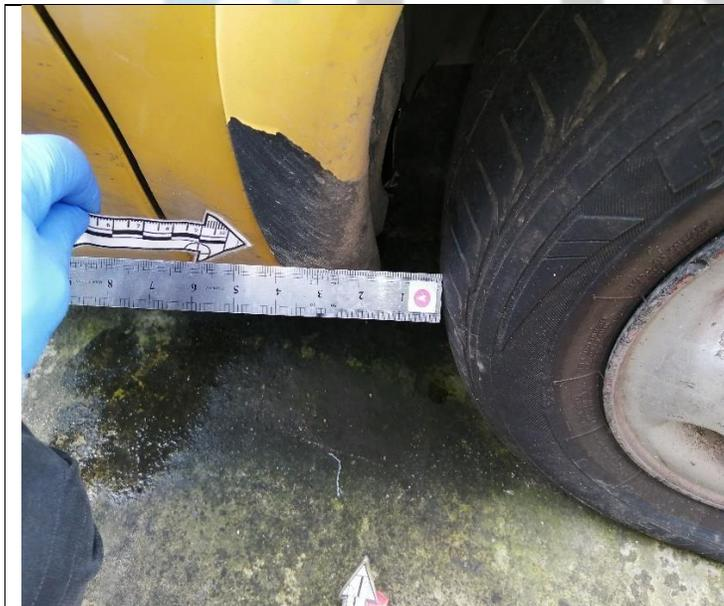
IMG. – 153901. Primer plano, tercio anterior derecho, unidad de rodadura presenta desviación en dirección hacia la parte posterior del vehículo por colisión generada por deformación de chasis, del vehículo de placas SJP-294.
