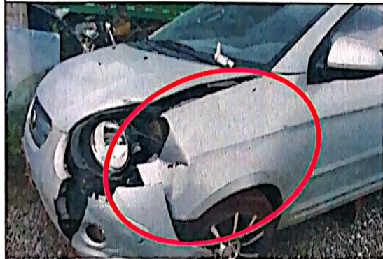
Imagen 5, se observa la nave del guarda fango delantero destruido.
