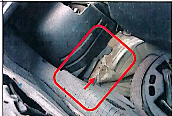
Imagen 14, se observa el baúl con desplazamiento hacia adelante.
