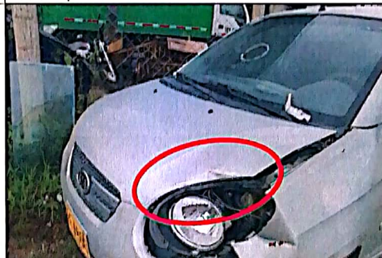
Imagen 6, se observa el capo lado izquierdo tercio anterior abollado en forma cóncava.
