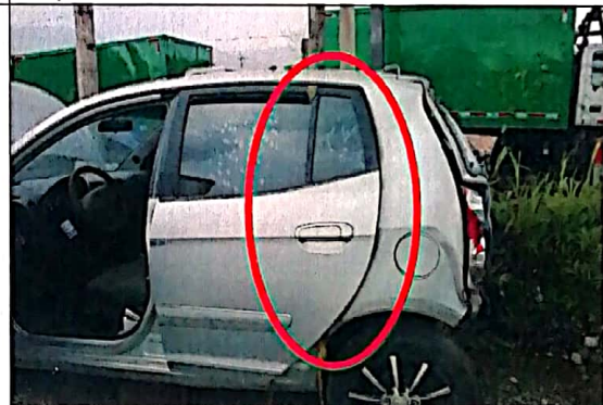
Imagen 16, se observa la nave del guarda fango trasero desplazado hacia adelante afectando la puerta trasera al cierre.
