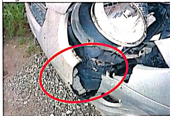
Imagen 7, se observa la punta del chasis delantero lado izquierdo tercio anterior abollado en forma cóncava.
