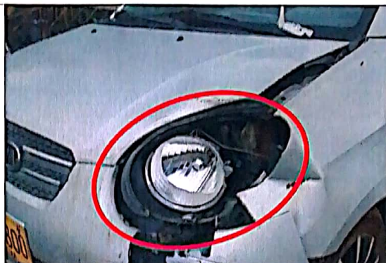
Imagen 4, se observa el conjunto de farola lado izquierdo destruida.
