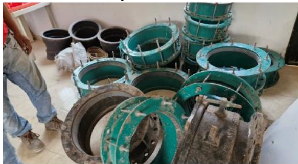
Ilustración 9. Tubería y accesorios Almacenados
