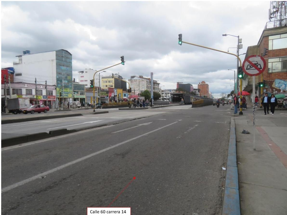
**Fotografía No. 1 Panorámica:** En esta fotografía tomada por el equipo de IRS Vial, en sentido sur – norte, en calle 60 con carrera 14, Bogotá, se aprecian las características generales de la vía, en la cual se encuentra con demarcación horizontal: línea continua blanca, línea de borde blanca, cruce peatonal, flechas, con señalización vertical: SR-48 (no bloquear cruce), semáforo, en este sentido se desplazaba el vehículo No 1 (automóvil).
