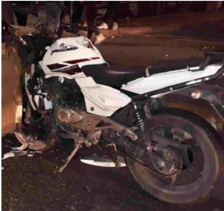
**Fotografía No. 8 Plano Medio:** En estas fotografías se observa el estado final del vehículo N 2, el cual presenta daños en la zona frontal, afectando la suspensión, carenaje y ausencia de la farola.
