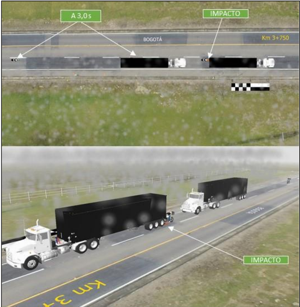
Imagen tomada del Dictamen Pericial RAT, página 33. Imagen compuesta de vista en planta y una reconstrucción en 3D de la secuencia de desplazamiento pre impacto y momento del impacto establecida para el evento en correlación con la evidencia registrada, análisis físico y velocidades calculadas.
