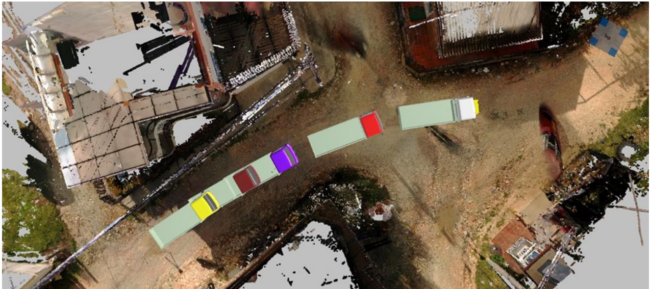
Figura No.6, vista de plano medio y en planta del lugar de los hechos, la cual ilustra la trayectoria relativa aproximada seguida por camioneta sobre la vía, hasta la zona de impacto. Tomada del software 3D zone.
