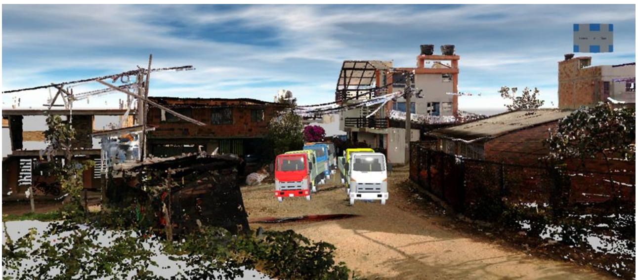
Figura No.12, vista de plano medio y en perspectiva del lugar de los hechos, en sentido norte – sur, la cual ilustra la trayectoria relativa aproximada, que pudo seguir la camioneta para evitar la colisión, con la secuencia de vehículos del naranja al rojo. (lado izquierdo), comparado con la trayectoria que siguió para que se produjera la colisión (lado derecho). Tomada del software 3D zone.
