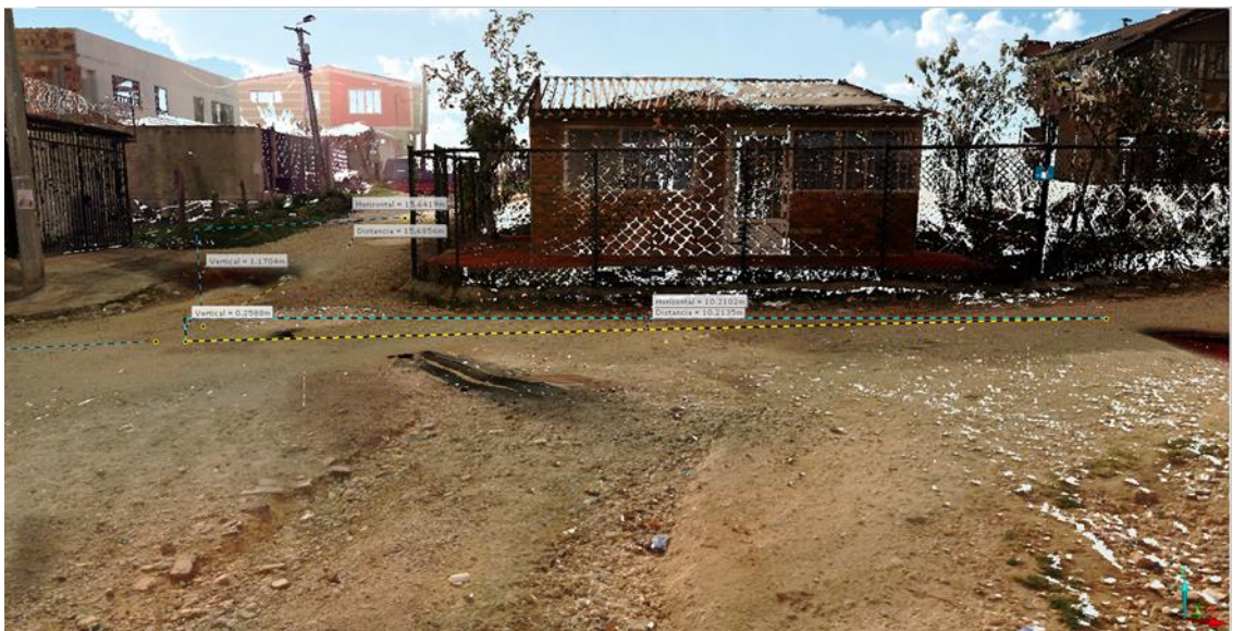
Figura No.4, vista en perspectiva de plano medio, en sentido oriente – occidente del lugar de los hechos, la cual ilustra la zona donde ocurrió el evento y con una pendiente longitudinal de 1.4° (2.45 %). Tomada del software Scene.
