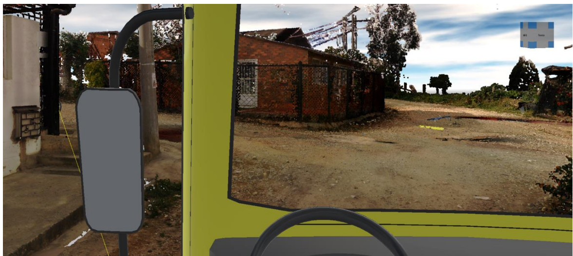
Figura No.14, Tomada del programa Software (3D zone) en la que se ilustra en perspectiva desde el interior de la camioneta de sur a norte la posición relativa aproximada de la camioneta viajando por el centro de la calzada entre un rango de 15 y 21 km/h, 1.5 segundos antes de llegar a la zona de intersección y el ciclista viajando por el carril izquierdo de la carrera 27, en sentido occidente a oriente entre un rango de velocidad de 14 y 25 km/h.
