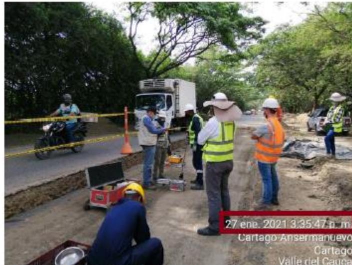
**Foto 6: Medición de Modulo elástico con LWD**
