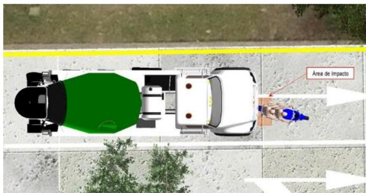
En las imágenes 2 y 3, tomadas del dictamen pericial de Reconstrucción de Accidente de Tránsito realizado por IRS VIAL, se observa cómo la trayectoria que recorrió la motocicleta (detallada previamente en la imagen 1 del croquis) coincide con todos los puntos ciegos del conductor del camión, incluyendo la posición final en la que quedó la motocicleta previo al momento del impacto.
