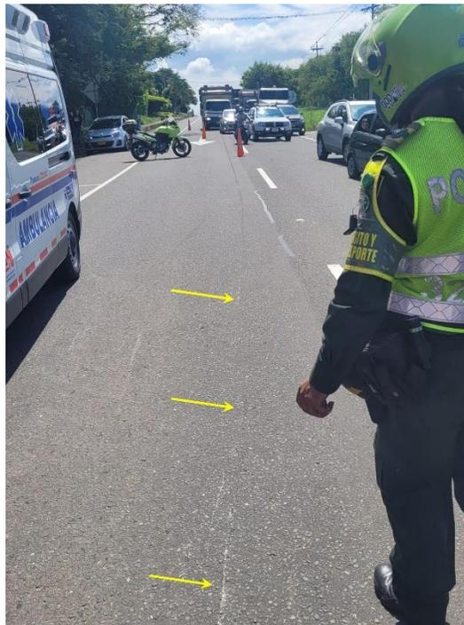
**Fotografías No. 20 y 21 Plano medio:** En estas fotografías tomadas el día de los hechos, se observa el inicio y final de la huella de frenado y una huella de arrastre.
