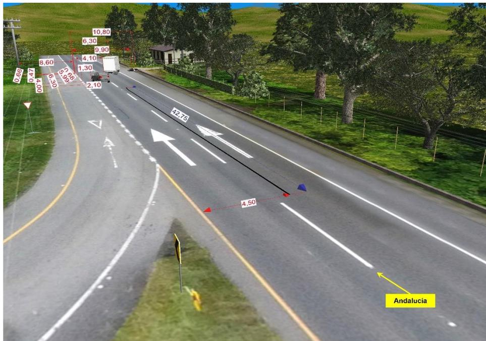
**Imagen No. 17:** En estas imágenes se observan dos vistas en 3D del bosquejo topográfico realizado a escala del lugar, elaborado en TRIMBLE FORENSICS REVEAL, en las que se muestra la ubicación de la evidencia física y el punto de referencia.
