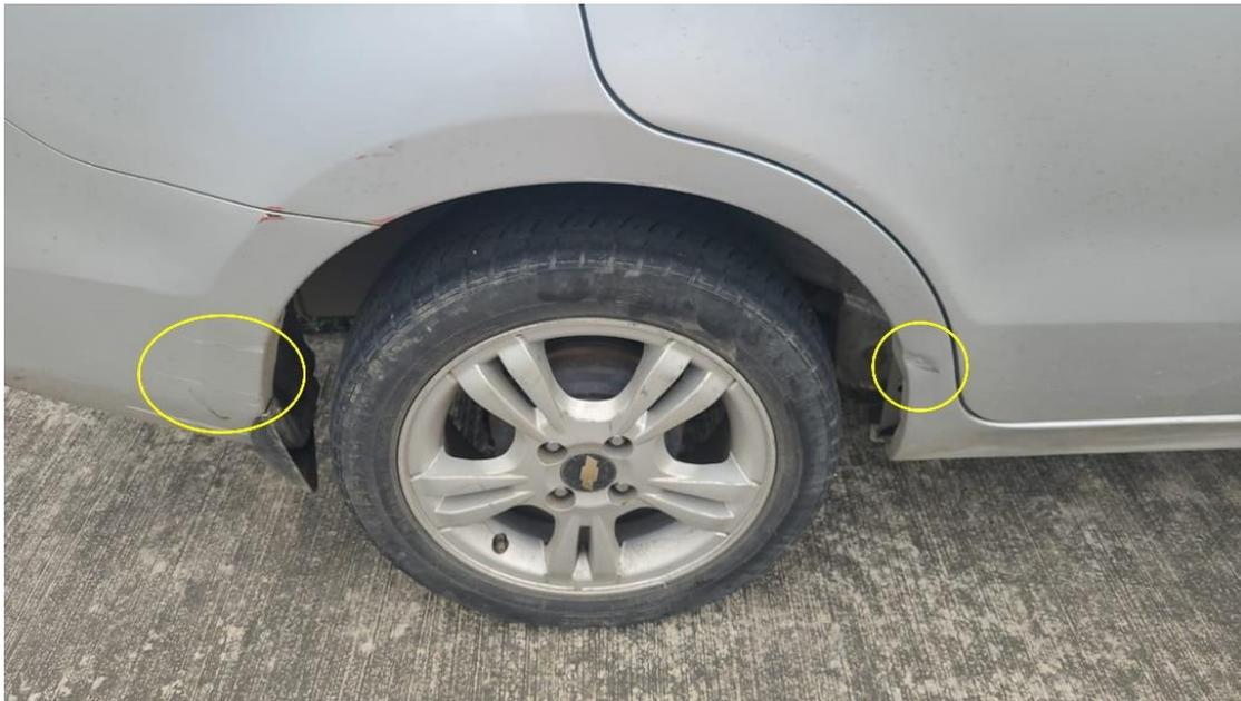
**Fotografía No. 16 Primer Plano:** En esta imagen se muestra la llanta posterior derecha del vehículo No. 2, se evidencian rayones y limpiezas en la llanta.
