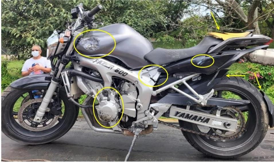
**Fotografía No. 15 Plano medio:** En esta imagen se muestra el costado izquierdo del vehículo No. 1, se evidencian abolladura en tanque de combustible, rotura en soporte y guardabarros trasero y abrasiones, así como rotura del asiento en parte posterior y ausencia de espejos retrovisores.
