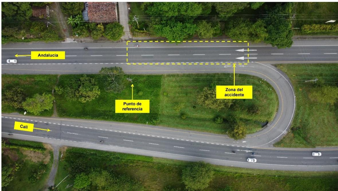
**Fotografía No. 1 Vista en planta:** En esta fotografía, tomada con DRONE, se observan las características generales de la vía Cali – Andalucía a la altura del kilómetro 61 + 250 metros, se evidencia que la calzada involucrada tiene demarcación de flechas de sentido vial, líneas de borde de pavimento y de carril.
