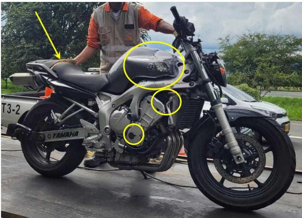
**Fotografía No. 14 Plano medio:** En esta imagen se muestra el costado derecho del vehículo No. 1, se evidencian abolladura en tanque de combustible, un doblez y la ausencia de una tapa, así como rotura del asiento en parte posterior y ausencia de espejos retrovisores.
