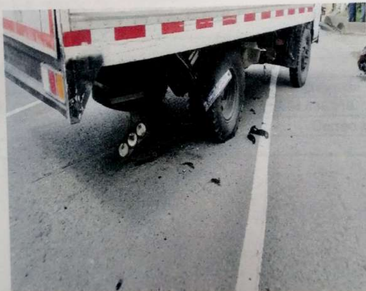
IMAGEN No. 7 FOTOGRAFIA PLANO MEDIO: Imagen donde se observa el vehículo los daños que presenta el vehículo tipo camión, servicio público, de placas VMB731, sobre el vértice posterior derecho desprendimientos de autopartes y partes faltantes lugar donde posteriormente colisiona el motociclista.
