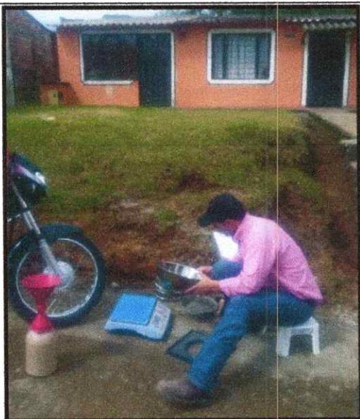
FOTOGRAFIA 5: TOMA DE DENSIDADES EN LA SUBBASE Y TIERRA AMARILLA EN EL RELLENO DEL TRAMO DESDE LA CAMARA 20 A LA CAMARA 19 DEL ALCANTARILLADO
