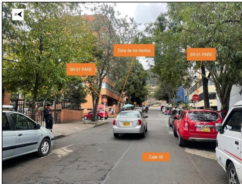
**Fotografía No.9 y 10 Plano General:** fotografía tomada sentido occidente oriente sobre la Calle 50, donde se observan las características generales del tramo de vía recta, plano, estado bueno, asfalto, intersección donde ocurren los hechos, único sentido de circulación, señalización horizontal flechas direccionales, bandas alertadoras, señalización vertical SR-01 PARE. En este sentido circulaba la Motocicleta.
